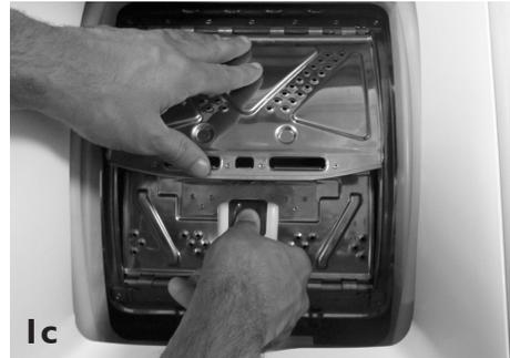
4. Pour fermer le tambour, maintenir les deux parties du tambour au milieu (fig. "2"), la porte arrière à travers la porte avant.
