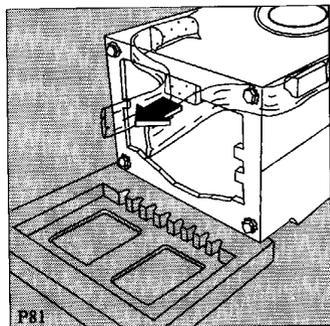
Enlever le bloc de polystyrène du fond de la machine; il n'est pas nécessaire de le conserver.
