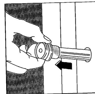
Verwijder de drie plastic afstandshulzen uit de gaten waar de schroeven in zaten.
