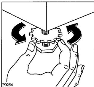
Schuif de wasautomaat op z'n definitieve plaats en stel de machine zo goed mogelijk waterpas op. Dat doet u door middel van het in- of uitdraaien van een of twee van de verstelbare voetjes. Zorg er voor dat de machine op alle vier de voetjes stevig tegen de vloer staat. Draai, na het waterpas stellen, de kontramoeren stevig tegen de machinebodem.
