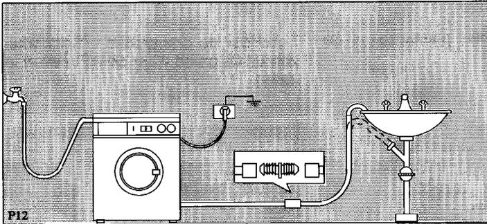
Draai, nadat u eerst het afdichtringetje in de wartel hebt gelegd, de wartel van de toevoerslang stevig op de 3/4'' schroefdraad van de kraan. Wat ons betreft hoeft de kraan niet «belucht» te zijn (de machine is voorzien van een beluchter), maar het kan zijn dat de gemeente waar u woont dat toch eist. Mocht het u bekend zijn dat de leidingwaterdruk soms zeer hoog is, leg dan een gummi kraanschijf 3/4'', 23x4x4mm, in de wartel aan de **machinekant** van de slang.
