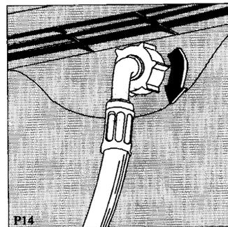
L'autre extrémité du tuyau de remplissage, du côté de la machine, peut être orientée dans n'importe quelle direction. Dévisser un peu la bague de serrage, tourner le bout du tuyau et revisser solidement la bague.
