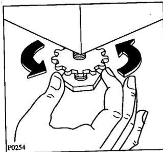
Placer la machine à laver dans sa position définitive et la mettre autant que possible de niveau, en vissant ou en dévissant un ou deux des vérins d'appui réglables. Veiller à ce que la machine soit bien stable sur les quatre vérins. Après la mise de niveau, bloquer les contre-écrous.
