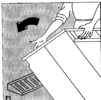
Coucher l'appareil sur le dos, en faisant attention à ne pas endommager les tuyaux.
