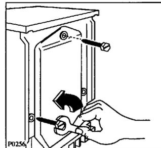
Remettre la machine debout et dévisser les 2 autres vis à l'arrière.
