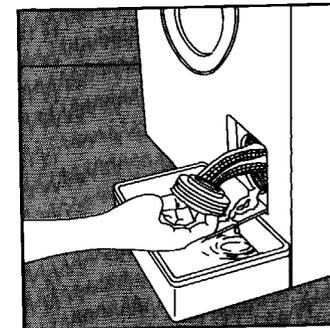
Plaats een schaalje onder het filterdeksel en schroef het filter los.
