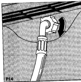
Het andere eind van de toevoerslang, aan de machinekant, kan naar alle richtingen verdraaid worden. Wartel iets losdraaien, haakse bocht verdraaien en wartel weer stevig vastdraaien.
