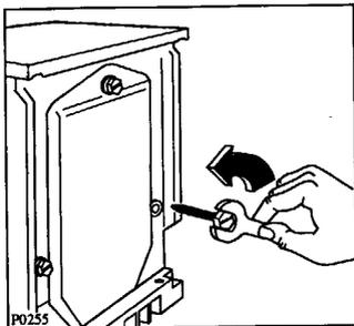
Dévisser à l'aide d'une clé la vis arrière droite.
