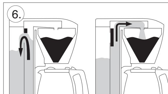
Ihr Melitta Single 5 ist mit einem Spezial-Ventil ausgestattet (Abb. 6). Es lässt das Wasser erst dann in den Filter, wenn es heiß genug ist. Vorher läuft es in den Wassertank zurück. Damit ist gewährleistet, dass auch bei Zubereitung von kleinen Tassenmengen das Kaffeepulver von Anfang an nur mit optimal erhitzen Wasser in Berührung kommt. Alle wertvollen Aromastoffe des Kaffees werden voll erschlossen – für einen Kaffee-Genuss und optimale Trinktemperatur von der ersten bis zur letzten Tasse.
