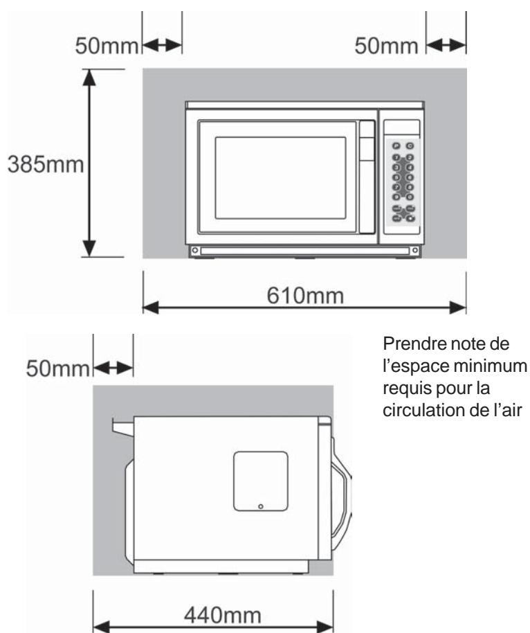
Positionner le four sur une surface plane HORIZONTALE, SOLIDE et STABLE. Laisser un espace d'au moins 50 mm à l'arrière, au-dessus et de chaque côté du four pour permettre à l'air de circuler librement autour du four (voir diagramme).
