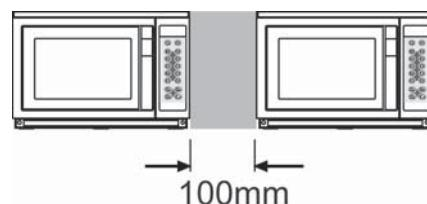
Remarque : Un espace minimum de 100 mm doit être laissé entre les deux fours mis côte à côte.
