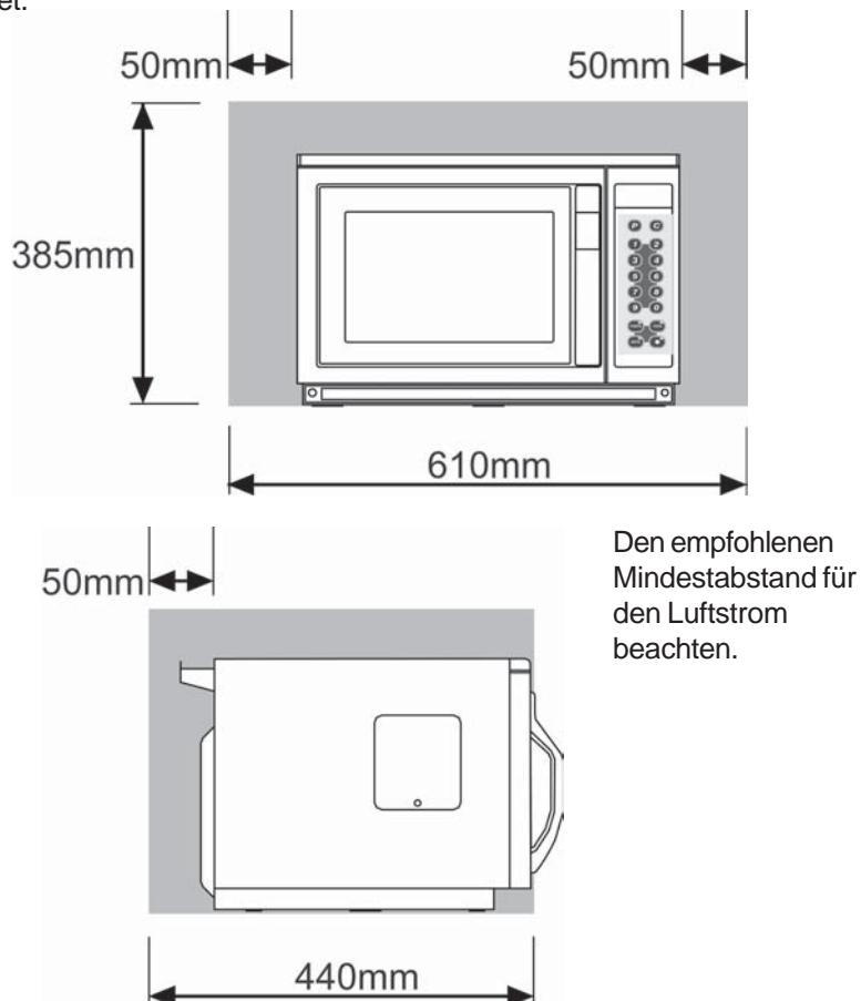
Den Mikrowellenherd auf eine flache, EBENE, FESTE und STABILE Oberfläche stellen.
