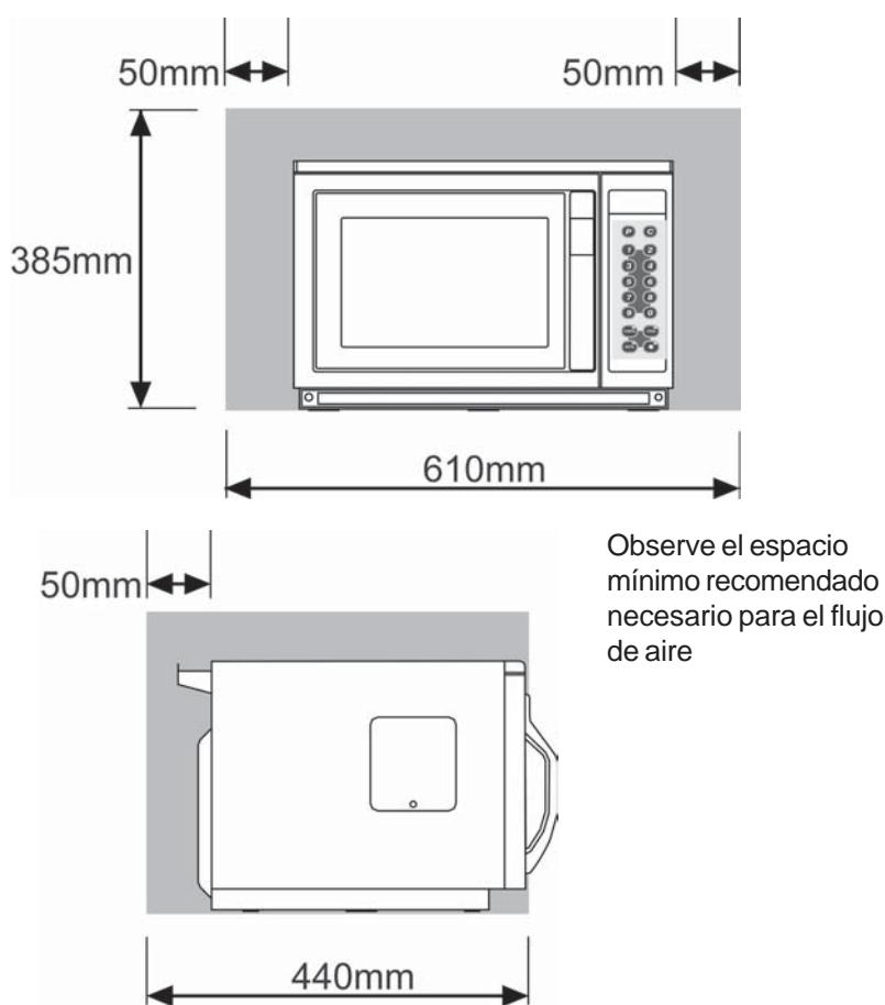
Coloque el horno en una superficie plana que esté NIVELADA y sea SÓLIDA y ESTABLE..
