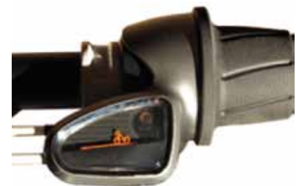
Dans cette position (« full overdrive »), le rapport de démultiplication est grand. Comme le montre le pictogramme, cette position est utilisée lorsque le terrain est plat ou en descente.
