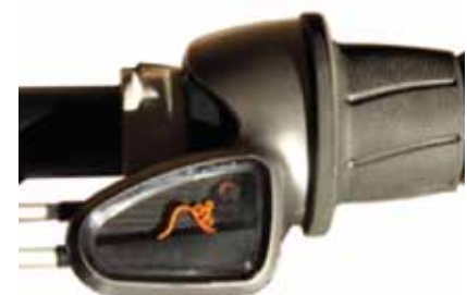
Dans cette position, le rapport de démultiplication est petit. Cette position est utilisée lorsque le terrain est en montée, lorsqu'il devient difficile de pédaler en gardant une cadence de jambes correcte.
