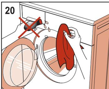
**ATTENZIONE!!** Non utilizzare assolutamente per la pulizia della macchina sostanze chimiche, prodotti abrasivi, alcol, sapone, benzine o altri solventi in quanto potrebbero danneggiare la macchina. (fig. 20)
