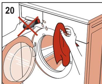
**ATTENTION!!** Pour le nettoyage de la machine, il ne faut absolument pas utiliser des substances chimiques, produits abrasifs, alcool, savon, essence ou tout autre type de solvant, étant donné que leur emploi est susceptible d'endommager la machine. (fig.20)
