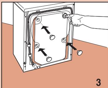
Pour des raisons de transport, le groupe oscillant de la machine est bloqué par 4 entretoises avec vis. Avant de mettre la machine en fonction, il faut retirer les vis de blocage à l'aide d'une clé.
