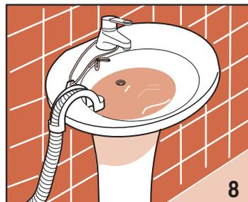
bre du tuyau doit être préalablement renforcée, en correspondance du point de pliage, avec un crochet approprié, fourni avec la machine. Ensuite, il faudra placer le tuyau sur le bord du lavabo et fixer le crochet de façon à ce que le tuyau ne tombe pas (fig. 8). L'écoulement du lavabo doit être propre, afin que l'eau puisse être évacuée librement.
