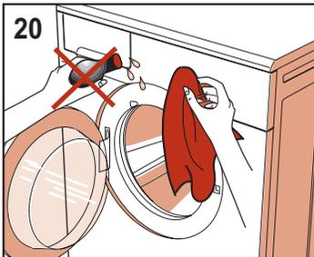
**ATENCIÓN!!** No utilizar de ninguna manera para la limpieza de la máquina sustancias químicas, productos abrasivos, alcohol, jabón, bencinas u otros disolventes porque pueden dañar la máquina. (fig.20)
