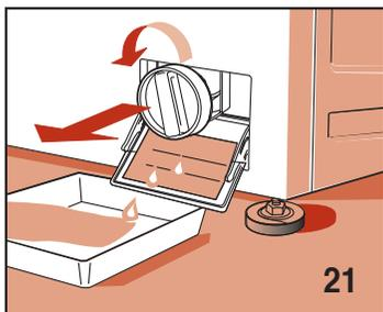
Mettre un chiffon sous le filtre ou bien une assiette pour recueillir l'eau qui est restée à l'intérieur dudit filtre. Ouvrir le volet du filtre, dévisser et retirer ce dernier en le tournant dans le sens contraire à celui des aiguilles d'une montre. (fig.21).
