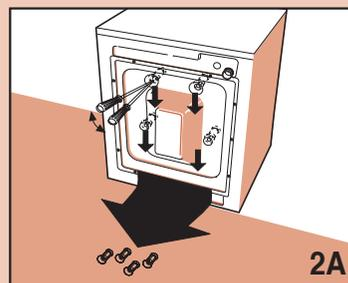
Introduza uma chave de parafusos nos orifícios e opere como indicado na figura para tirar os 4 espaçadores de plástico.
