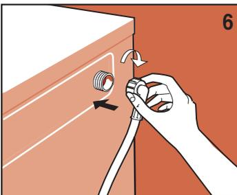
■ E' importante non allacciare ermeticamente il tubo della macchina alla condotta di scarico per evitare di riempire d'aria il sifone e, di conseguenza, di provocare la fuoriuscita dell'acqua.
