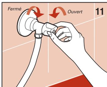
correctement (voir connexion hydraulique) et que le robinet soit ouvert.
