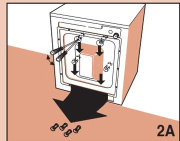
Introducir en los orificios un destornillador y operar como se indica en la figura para poder recuperar los 4 separadores de plástico.
