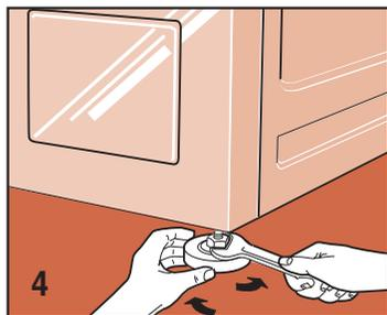
Après avoir choisi l'emplacement approprié, régler correctement le plan de la machine à l'aide des pieds réglables (Fig. 4). Faire particulièrement attention au choix de la position, au nivellement de la machine à laver le linge et à la sécurité des contre-écrous.
