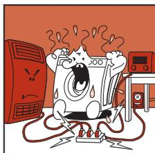
Il est interdit de brancher la machine à laver le linge à la prise électrique en utilisant des rallonges ou des fiches multiples.
