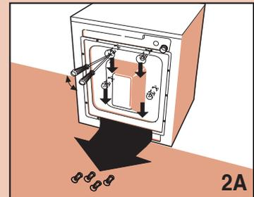
Inserire nei fori un giravite e agire come in figura per poter recuperare i 4 distanzieri in plastica.
