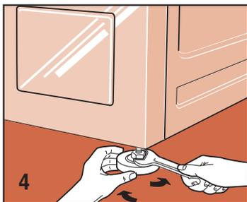
Depois de ter decidido o sítio em que deseja montar a máquina, coloque a máquina perfeitamente horizontal, utilizando os pés reguláveis (Fig. 4). Dedique especial atenção à escolha da posição, à nivelção da própria máquina e à segurança das contraporcas.
