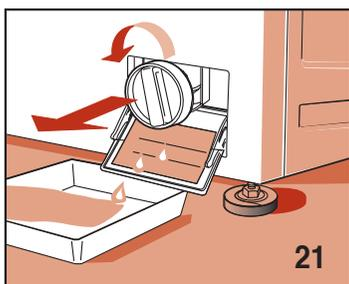
Coloque um pano ou um prato ladeiro por baixo do filtro para recolher a água que ficou depositada no interior da máquina. Abra a portinhola do filtro. Desaperte o filtro e tire-o para fora, rodando no sentido contrário ao dos ponteiros do relógio (fig. 21)
