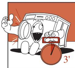
Après avoir terminé le lavage, il faut attendre pendant trois minutes environ avant de pouvoir ouvrir le hublot, étant donné qu'un dispositif de sécurité de protection contre les ouvertures accidentelles est placé sur l'ouverture.
