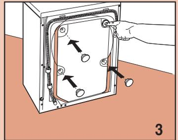
Por motivos de transporte el grupo oscilante de la máquina está bloqueado con 4 separadores con tornillos. Antes de hacer funcionar la máquina quitar los tornillos de bloqueo con una llave.
