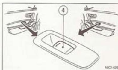
Interrupteurs de lève-vitres électriques côté passager
