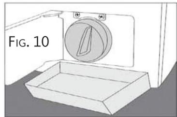
4. Desserrez le couvercle du filtre en le faisant tourner dans le sens inverse des aiguilles d'une montre et laissez l'eau couler (Fig. 11).
