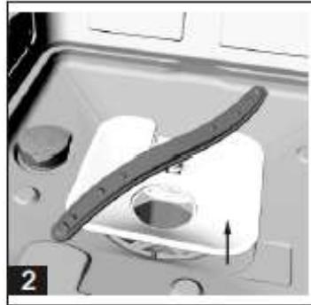
4. Draai de micro filter linksom en verwijder deze.
