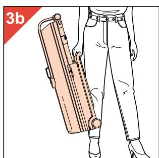
Se dovete sollevare l'apparecchio da soli, vi consigliamo di usare l'impugnatura (C) (fig. 3b). N.B.: l'apparecchio pesa oltre 28 kg.
