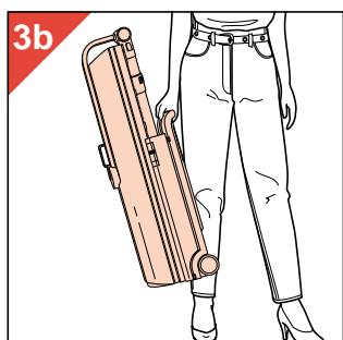
Hvis solariet må løftes av en person, er det tilrådelig å bruke håndtaket (C) (fig. 3B). NB! Apparatet veier over 28 kg.
