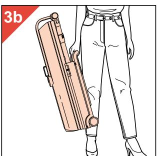
Als u het solarium alleen moet tillen, gebruik dan de handgreep (C) (fig. 3b). Let op: het apparaat weegt meer dan 28 kg.
