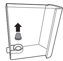
**2** Verwijder het filter uit de houder in het waterreservoir en spoel het filter af onder de kraan.
