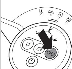
**Remarque :** Si la machine à café s'arrête lors de la préparation du café, le réservoir d'eau ou la recharge de café en grain est probablement vide ou le bac à marcs de café est plein. Remplissez le réservoir d'eau, remplacez la recharge de café en grain ou videz le bac à marcs de café et réappuyez sur le bouton pour 1 tasse ou 2 tasses pour terminer le cycle de préparation.
