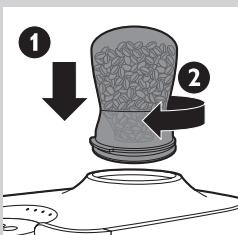
**3** Plaats de schroefdraad van de bean-funnel goed in de opening aan de bovenkant van de koffiezetter (1). Draai de bean-funnel vervolgens rechtsom om deze te bevestigen (2).
