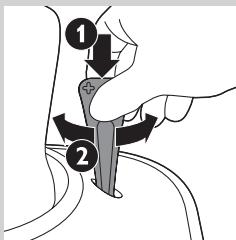
**8** Pour un réglage plus grossier, appuyez vers le bas et tournez l'outil de réglage du niveau de mouture dans le sens des aiguilles d'une montre. Pour une mouture plus fine, appuyez vers le bas et tournez l'outil de réglage du niveau de mouture dans le sens inverse des aiguilles d'une montre.
