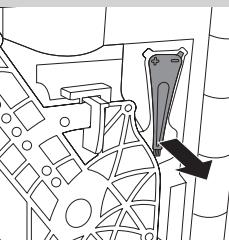
**3** Neem het hulpmiddel voor het aanpassen van de maaalsterkte uit de uitsparing naast de zetgroep.
