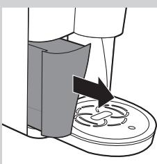
**1** Retirez le réservoir d'eau de la machine à café.
