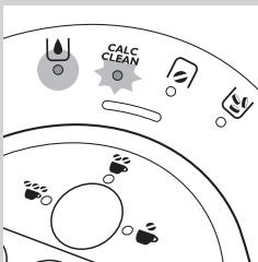
**6** Wanneer het activiteitslampje uit gaat, het 'waterreservoir leeg'-lampje gaat branden en het CALC CLEAN-lampje snel begint te knipperen, leegt u de kom en spoelt en vult u het waterreservoir.
