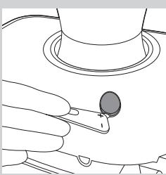
**6** Steek het nokje op het brede uiteinde van het hulpmiddel voor het aanpassen van de maaalsterkte naast de dop van het maaalsterkteaanpassingsgat en druk zachtjes. Hierdoor opent de dop automatisch.
