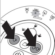
**5** Appuyez sur le bouton pour 1 tasse et sur le bouton pour 2 tasses simultanément pendant 1 seconde pour démarrer le cycle de rinçage.
