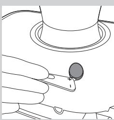
**6** Insérez l'extrémité la plus large de l'outil de réglage du niveau de mouture à côté du capuchon de la zone de réglage de niveau de mouture et appuyez légèrement. Cette action entraîne l'ouverture automatique du capuchon.
