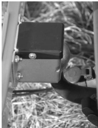
Jetzt können Sie den Fahrradträger mit der Kupplung auf die Anhängerkupplung von Ihrem KFZ montieren. Drehen Sie die dicke Schraube (M16x90) leicht fest. Kontrollieren Sie danach, ob der Träger parallel zu Ihrem Fahrzeug steht (Stoßfänger von Ihrem KFZ). Schrauben Sie danach mit dem mitgelieferten Schlüssel den Träger auf die Anhängerkupplung fest bis dieser sich nicht mehr bewegt.
