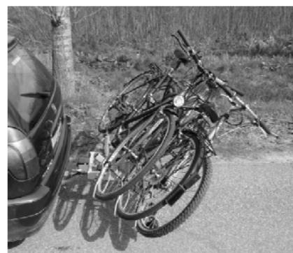
Om de drager weer in de uitgangspositie te brengen, tilt u de fietsendrager omhoog en duwt u de hendels weer naar binnen. Vervolgens draait u deze een kwart slag zodat ze weer verticaal staan met het lange gedeelte naar beneden. U hoort een klik als ze vergrendeld zijn.
