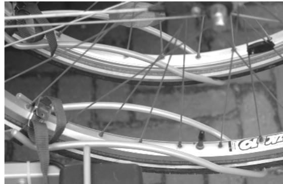
Attacher vous-même le vélo sur l'attache-vélo. L'attache-vélo est adaptable, il existe plusieurs positons. Il est important de placer l'attache-vélo le plus haut possible. Fixer le vélo par les sangles. Par ces sangles chaque vélo peut être fixé et le cadre du vélo ne subit aucune pression.
