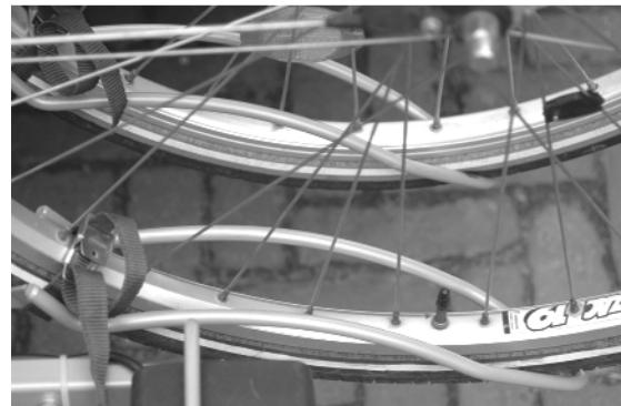
Befestigen Sie die Fahrräder mit den Rahmenhaltern an dem Bügel. Da die Rahmenhalter nicht platzgebunden sind, können Sie mehrere Positionen ausprobieren. Es ist wichtig das Sie die Rahmenhalter so hoch wie möglich platzieren. Die Fahrradrahmen machen Sie mit den Spannbändern fest. Durch den Gebrauch dieser Spannbänder kann das Fahrrad einfach und bequem fest gemacht werden und die Pedale werden nicht belastet!
