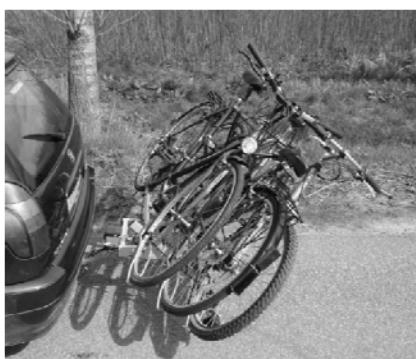
Um den Träger wieder in die Ausgangsposition zu bringen, heben Sie den Fahrradträger an und drücken die Griffe wieder nach innen. Anschließend drehen Sie diese eine viertel Drehung, sodass diese wieder vertikal stehen (Handriffe waagerecht). Sie hören ein Klick wenn die Verriegelung korrekt ist.
