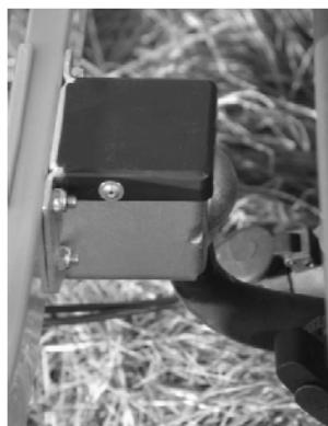
Van bovenaf kan de fietsendrager met de koppeling op de trekhaak van uw auto gemonteerd worden. Draai vervolgens de dikke bout (M16x90) licht vast. Controleer daarna of de drager parallel loopt met uw auto (of bumper van uw auto). Schroef daarna met de bijgeleverde sleutel de bout stevig vast totdat de drager niet meer kan bewegen op de trekhaak.
