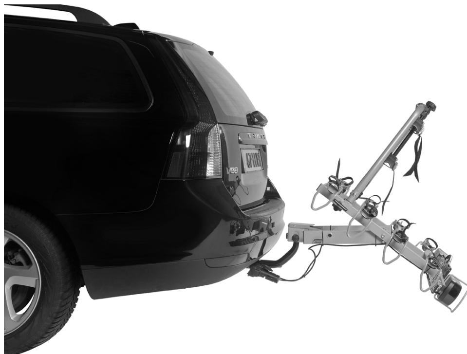
Om de drager weer in de uitgangspositie te brengen, tilt u de fietsendrager omhoog en duwt u de hendels weer naar binnen. Vervolgens draait u deze een kwart slag zodat ze weer verticaal staan met het lange gedeelte naar beneden. U hoort een klik als ze vergrendeld zijn.
