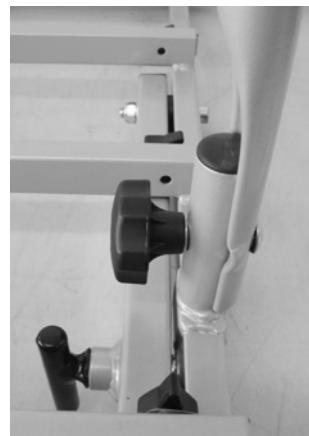
Achtung: Sie sollen beide Kunststoff Rändelmuttern sehr fest anziehen, sodass der U-Bügel sich passgenau auf die U- Bügelhalterung ansetzt.
