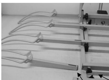
Schieben Sie die acht Radhalter in die Öffnungen von dem Basisteil. Achten Sie darauf, dass die Enden der Radhalter beim Einschieben mit der Spitze zum Boden zeigen (siehe Abbildung). Befestigen Sie die Radständer mit den Rändelschrauben. Beim Einstellen der Radständer dürfen diese nur maximal bis zur roten Markierung herausgezogen werden!
