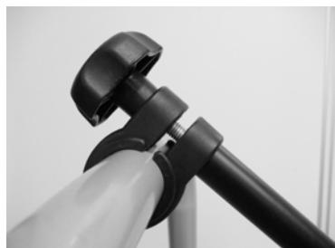
Draai de kunststof knop van elke framehouder helemaal los, zodat de klemsluiting opengevouwen kan worden. Plaats eerst de kunststoffen ring om de U-vormige beugel en klem hier de klemsluiting overheen. Bevestig hier vervolgens de houder weer aan en draai de kunststoffen knop zodanig aan dat de framehouders nog net draaibaar zijn (hier moeten immers de frames van de fietsen aan bevestigd worden). De spanbandzijde dient ter bevestiging van de fiets.
