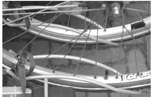
Befestigen Sie die Fahrräder mit den Rahmenhaltern an dem Bügel. Da die Rahmenhalter nicht platzgebunden sind, können Sie mehrere Positionen ausprobieren. Es ist wichtig das Sie die Rahmenhalter so hoch wie möglich platzieren. Die Fahrradrahmen machen Sie mit den Spannbändern fest. Durch den Gebrauch dieser Spannbänder kann das Fahrrad einfach und bequem fest gemacht werden und die Pedale werden nicht belastet!
