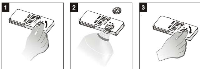
**REMARQUE** : Lorsque l'indicateur visuel devient clair, ou lorsque le témoin de niveau de liquide s'allume, le réservoir a besoin d'être rechargé.
