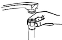
Vissez le connecteur droit du tuyau d'arrivée au robinet et serrez bien; les rondelles doivent impérativement être bien en place à chaque bout du tuyau.
