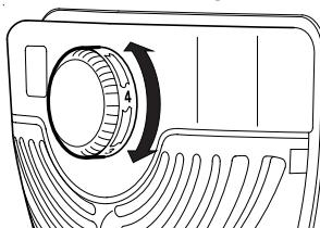
Temperatura interioară este reglată cu ajutorul termostatului comandat de butonul situat în interiorul aparatului.
