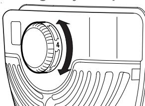
Temperatura wewnętrzna może być regulowana za pomocą termostatu obsługiwanej przyciskiem, który znajduje się wewnętrz urządzienia.
