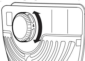
La température intérieure est réglée par le thermostat commandé par le bouton situé à l'intérieur de l'appareil.
