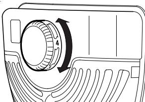
La temperatura interior se regula con el termostato, que dispone de un botón dentro del aparato.
