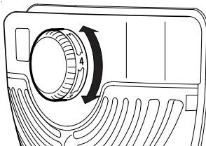
La temperatura interna viene regolata tramite il termostato comandato dal pulsante situato all'interno dell'apparecchio.
