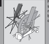
Fjern hjulmøtrikken på den side af cyklen, som vender mod trafikken. Placer cykellysets monteringsbeslag på hjulakslen. Vær sikker på, at beslaget er vendt. Sæt hjulmøtrikken på igen, og spænd den godt fast.
