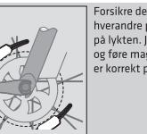
Forsikre deg om at magnetene sitter overfor hinandens på samme side av hjulet og ved merket på lykten. Juster posisjonen ved å løse skruene og føre magnetene opp eller ned. Når magnetene er korrekt positionert, strammes skruene helt.
