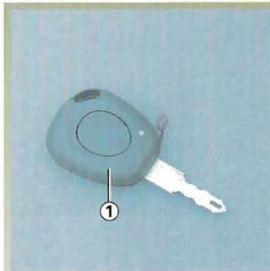
1 Télécommande à radiofréquence, clé de contacteur-démarrreur, des portes, du coffre et de la trappe à carburant.
