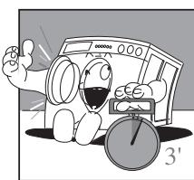
**No fim da lavagem, é necessário aguardar cerca de três minutos antes de abrir a porta. A máquina está equipada com um dispositivo de segurança no sistema de abertura que serve para proteger o utilizador de aberturas accidentais. Observação: nos modelos electrónicos a porta abrirá na altura em que acende a luz piloto "end".**
