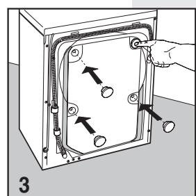
Für den Transport wird die Schwinggruppe des Gerätes mit 4 Transportsicherungen und Schrauben fixiert. Vor Inbetriebnahme des Waschautomaten die Transportsicherungen und Schrauben mit Hilfe eines Schraubenschlüssels entfernen.
