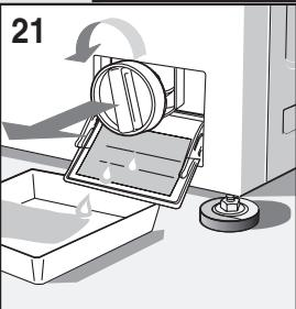
**ACHTUNG!** Vor Reinigen des Filters muss sichergestellt werden, dass die Maschine leer ist. Den Filter nicht ausbauen, während die Waschmaschine funktioniert oder Wasser enthält.
