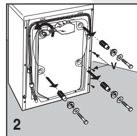
Die Löcher mit den entsprechenden Stöpseln verschließen, die Sie im Plastikbeutel mit der Dokumentation finden.
