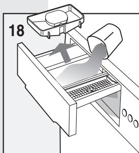
**Atenção! Não tire a gaveta de detergente durante o funcionamento da máquina porque pode sair água.**
