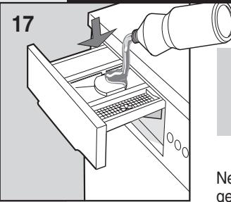
**REMARQUE:** Lorsque l'on utilise le détergent liquide (recommandé pour les programmes sans pré lavage), insérer le récipient spécial (si prévu) dans la cuvette intermédiaire "2" (de la façon illustrée ci-contre), puis verser le détergent liquide jusqu'au niveau maximum indiqué.
