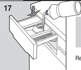
**N.B.** Cuando se usa el detergente líquido (recomendado para programas sin prelavado), introducir el contenedor especial (si previsto) en la cubeta intermedia "2"(de la manera que se ilustra al lado), luego vaciar el detergente líquido hasta el nivel máximo indicado.
