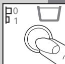
Presionando este pulsante, la lavadora se detiene automáticamente al final del último enjuague y antes de descargar el agua. En este caso la ropa sumergida en el cesto lleno de agua no se arruga. La función es posible solamente durante la ejecución de los lavados delicados.
