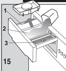
Die Waschmaschine ist mit einer Waschmittelschublade mit drei Kammern ausgestattet.
