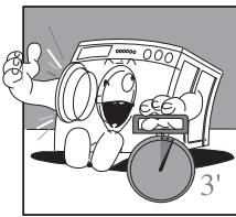
**Après avoir terminé le lavage, il faut attendre pendant trois minutes environ avant de pouvoir ouvrir le hublot, étant donné qu'un dispositif de sécurité de protection contre les ouvertures accidentnelles est placé sur l'ouverture.**
