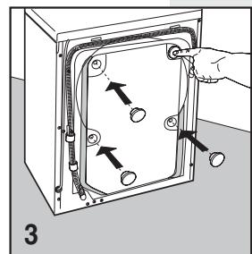
Pour des raisons de transport, le groupe oscillant de la machine est bloqué par 4 entretoises avec vis. Avant de mettre la machine en fonction, il faut retirer les vis de blocage à l'aide d'une clé.
