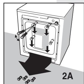
Einen Schraubenzieher in die Löcher einführen und die 4 Transportsicherungen aus Plastik entfernen, wie in der Abbildung gezeigt.
