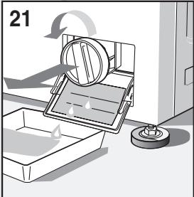
**ATENÇÃO !!** Antes de começar a fazer as operações descritas abaixo, assegure-se de que a máquina está vazia. Não tire o filtro durante o funcionamento da máquina ou quando esta estiver cheia de água.
