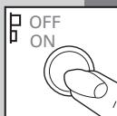
Para poner en marcha la máquina tirar la mando timer hacia el exterior, o si la máquina está dotada de pulsante presionarlo.
