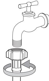
2. Schließen Sie den Frischwasserschlauch an den Wasseranschluss an.
