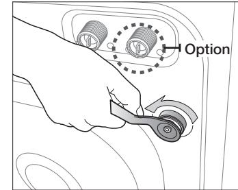
2. Halten Sie den Bolzen mit dem Schraubenschlüssel, und ziehen Sie ihn durch die breite Aussparung an der Öffnung. Dieser Vorgang muss für alle Transportsicherungen ausgeführt werden.
