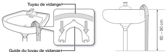
2. **Raccordé au tuyau d'évacuation du lavabo** : le tuyau d'évacuation doit être situé au-dessus du siphon du lavabo, afin que son extrémité soit au moins à 60 cm du sol.
