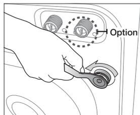
2. Maintenez la vis avec la clé et faites-la glisser vers l'extérieur le long de la partie large du trou. Répétez l'opération pour chaque vis.
