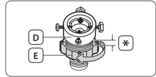
4. Raccordez l'adaptateur au robinet en serrant fermement toutes les vis et en levant l'adaptateur vers le haut.
