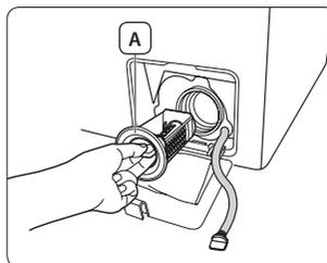
4. Retirez toute impureté et autre corps étranger pris dans le filtre et nettoyez ce dernier. Assurez-vous que l'hélice de la pompe de vidange située derrière le filtre n'est pas bloquée.
