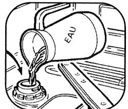
**⚠ En cas de débordement du sel régénérant lors du remplissage, il est recommandé d'enlever les cristaux de sel pour éviter l'oxydation de la cuve.**
