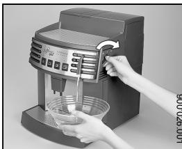
Drehknopf auf Heisswasser stellen. Ca. 2 dl Wasser ausfliessen lassen und Drehknopf wieder schliessen. Dies ist auch notwendig, wenn versehentlich der Wassertank nicht richtig eingesetzt ist (nur Modell mit Wasserbehälter) und die Kontrollanzeige
