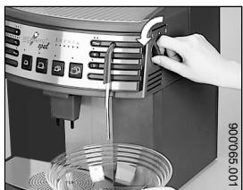
5. Drücken Sie jetzt die Reinigungstaste
