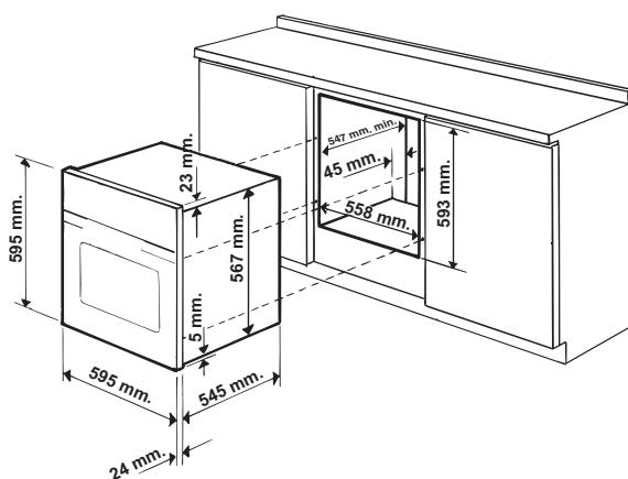
! Nadat het apparaat is ingebouwd, mag er geen contact meer mogelijk zijn met de elektrische onderdelen. Het gebruik dat staat aangegeven op het typeplaatje is gebaseerd op dit soort installatie.
