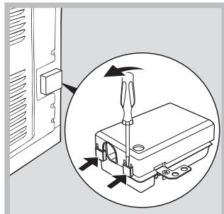
1. Pour ouvrir le bornier, faites pression à l'aide d'un tournevis sur les languettes latérales du couvercle : tirez et ouvrez le couvercle (*voir figure*).
