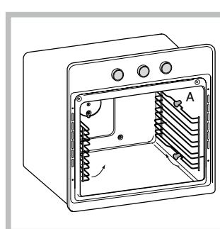
1. Verwijder de twee draagrekken door ze uit de afstandeleiders A te trekken (*zie afbeelding*).
