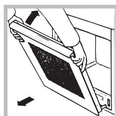
3. pak de deur aan de zijkanten beet en sluit hem langzaam, maar niet helemaal. Trek dan de deur naar u toe en haal hem uit zijn voegen (*zie afbeelding*). Zet de deur weer op zijn plaats door deze handelingen in omgekeerde volgorde uit te voeren.
