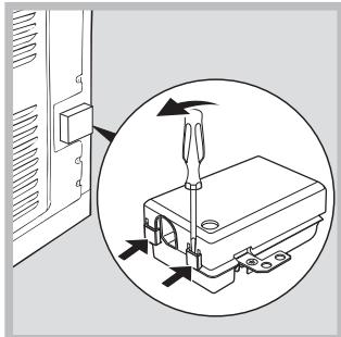
1. Licht de lipjes aan de zijkant van het deksel van het klemmenbord open met een schroevendraaier: trek het deksel van het klemmenbord open (*zie afb.*).
