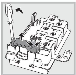
1. Öffnen Sie das Klemmengehäuse, indem Sie unter Zuhilfenahme eines Schraubenziehers die seitlichen Zungen des Klemmengehäusedeckels anheben. Ziehen Sie den Deckel ab (*siehe Abbildung*).
