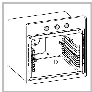
3. Befestigen Sie die mit den Gleitschienen versehenen beiden Rahmen in den entsprechenden Löchern der Backofenrückwand (siehe Abbildung). Die oberen Löcher sind für den linken Rahmen bestimmt, die unteren dagegen für den rechten Rahmen.
