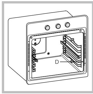
3. Fixez les deux cadres à gradins avec glissières assemblées dans les trous prévus sur les parois du four (voir figure). Les trous pour le cadre de gauche sont placés en haut tandis que les trous pour celui de droite sont placés en bas.
