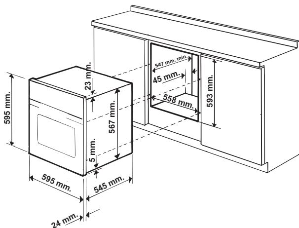
! Una volta incassato l'apparecchio non debbono essere possibili contatti con le parti elettriche. Le dichiarazioni di consumo indicate in targhetta caratteristiche sono state misurate con questo tipo di installazione.
