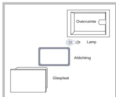
1. Dient u het glazen lampenkapje los te halen met behulp van een schroevendraaier.
