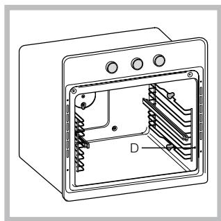
3. Bevestig de twee draagrekken, met de glijders gemonteerd, in de betreffende gaten op de wanden van de oven (zie afbeelding). De gaten voor het linker draagrek bevinden zich aan de bovenkant, terwijl de gaten voor het rechter draagrek zich aan de onderkant bevinden.
