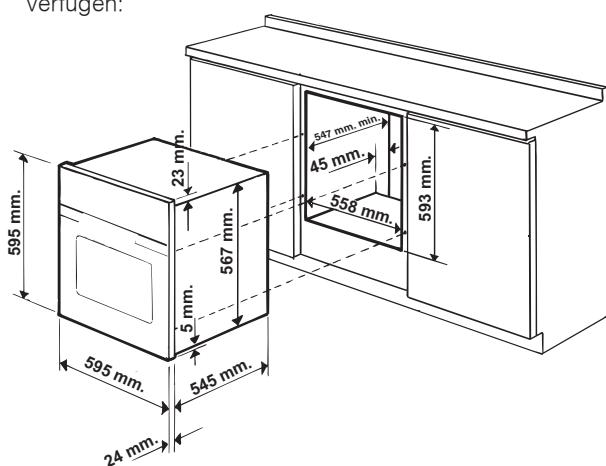
! Nach dem Einbau des Gerätes muss eine Berührung mit den Elektroteilen ausgeschlossen sein. Die auf dem Typenschild enthaltenen Verbrauchsangaben wurden bei dieser Art der Installation ermittelt.
