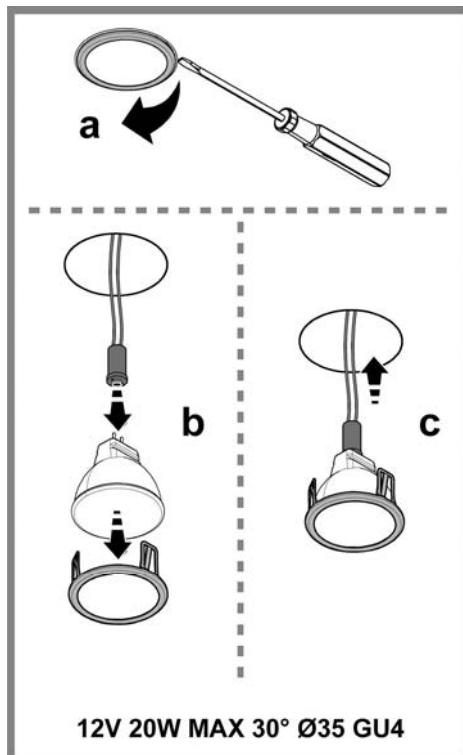
**Sostituzione lampade laterali.**
