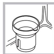
1. Extraiga el cesto inferior y desenrosque el tapón del depósito girando en sentido antihorario.
