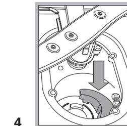
Après avoir nettoyé les filtres, remettre soigneusement le groupe filtrant à sa place, cette opération est fondamentale pour un bon fonctionnement du lave-vaisselle.
