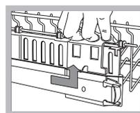
Ist der Korb mit "Dual Space"-Griffen ausgestattet (siehe Abbildung), ziehen Sie den Oberkorb bis zum Anschlag heraus, fassen die an den Korbseiten befindlichen Griffe mit den Händen, ziehen diese nach oben bzw. drücken sie nach unten, und
