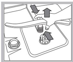
De onderste sproeiarm haalt u uit elkaar door druk uit te oefenen op de lipjes aan de zijkant en door hem daarna naar boven te trekken.
