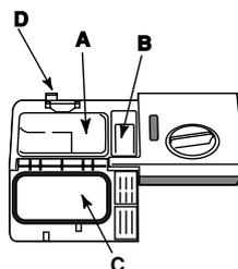
1. Öffnen Sie den Deckel C und drücken Sie die Taste D.
