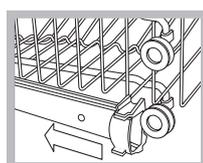
Öffnen Sie den rechten und linken Arretierstift der Korbführungen und ziehen Sie den Korb heraus; schieben Sie ihn in Hoch- oder Niedrigstellung ein; lassen Sie ihn über die Führungen nach hinten gleiten und schieben Sie hierbei auch die Vorderräder ein; schließen
