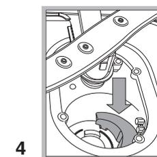
Após a limpeza dos filtros, monte novamente o grupo filtrante e coloque-o correctamente na sua posição; isto é fundamental para o bom funcionamento da máquina de lavar louças.
