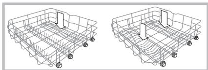
Alguns modelos de máquinas de lavar louça dispõem de sectores inclináveis\* que podem ser usados em posição
