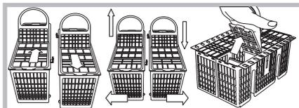
O cesto decomponível pode ser dividido em duas partes, solução indicada quanto se efectua
