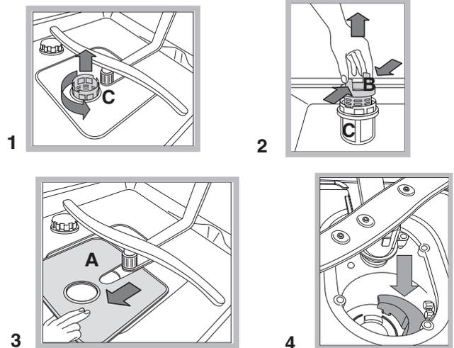
Después de la limpieza de los filtros, vuelva a montar el grupo filtrante y a colocarlo correctamente en su lugar. Esto es fundamental para el buen funcionamiento del lavavajillas.
