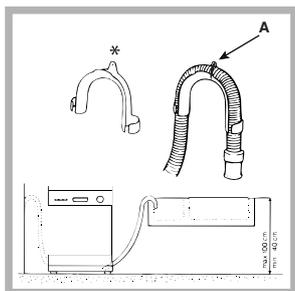
Lo speciale gomito\* in plastica agevola una sistemazione ottimale: fissare saldamente il gomito al muro per evitare che il tubo si muova e versi l'acqua fuori dallo scarico. La parte del tubo contrassegnata con la lettera A deve essere a un'altezza compresa tra 40
