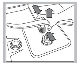
Um den unteren Sprüharm abzunehmen, drücken Sie die beiden seitlichen Zungen nach unten und ziehen dann den Arm nach oben hin ab.
