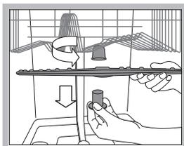
Zur Abnahme des oberen Sprüharmes drehen Sie den Kunststoffring gegen den Uhrzeigersinn ab. Der obere Sprüharm ist mit nach oben gerichteten Löchern wieder einzusetzen.
