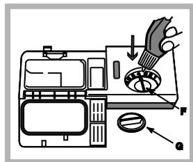
1. Aprire il serbatoio ruotando il tappo (G) in senso antiorario.
