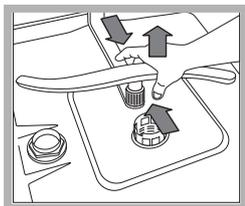
L'irroratore inferiore si smonta facendo pressione sulle linguette poste ai lati e tirandolo verso l'alto.
