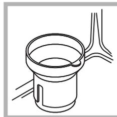
1. Estrarre il cesto inferiore e svitare il tappo del serbatoio in senso antiorario.
