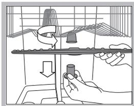
Para desmontar o aspersor superior deve-se desapertar girando o aro de plástico na direcção anti-horária. O braço aspersor superior deve ser remontado com os furos para cima.
