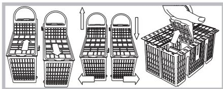
Der teilbare Besteckkorb kann zweigeteilt werden - somit kann eine Korbhälfte entfernt werden, eine praktische
