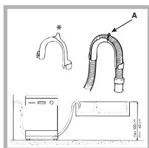
Un coude\* plastique spécial facilite une installation optimale : fixer solidement le coude au mur pour éviter que le tuyau se déplace et déverse l'eau hors du conduit.
