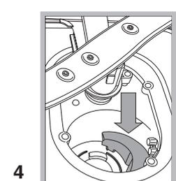
Na het reinigen van de filters dient u de filtergroep weer op zijn plaats te zetten. Dit is fundamenteel voor een goede werking van de afwasautomaat.
