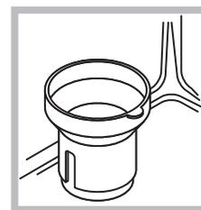
1. Sortir le panier inférieur et dévisser le couvercle du réservoir dans le sens inverse des aiguilles d'une montre.
