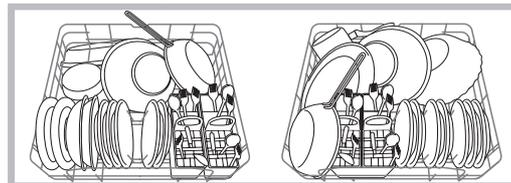
**Messer- und Kristallkorb\*** Einige Spülmaschinenmodelle haben zusätzlich einen Messer- und Kristallkorb, mit dem Messer, Geräte mit scharfen Spitzen und Kristall sicher abgelegt werden können und eine optimale Reinigung ermöglicht wird. **Der Korb kann nur auf der rechten Seite des oberen Geschirrkorbes eingesetzt werden.**
