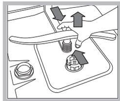
Pour démonter le bras supérieur, il faut dévisser la bague de fixation en plastique (tourner dans le sens inverse des aiguilles d'une montre). Il faut remonter le bras gicleur supérieur, orifices orientés
