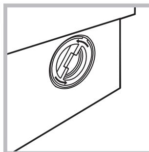
1. desenrosque la tapa girándola en sentido antihorario (*ver la figura*): es normal que se vuelque un poco de agua;
