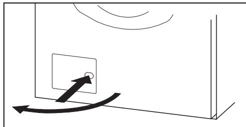
3. Faites sortir le tuyau de vidange, retirez-en le bouchon de fermeture, laissez l'eau s'écouler dans un récipient. Répétez éventuellement l'opération plusieurs fois.
