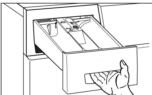
► Tirez le bac à lessive jusqu'à la butée. Versez la lessive ou le produit d'entretien dans les logement I, II ou ☈:
