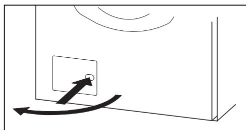
3. Entleerungsschlauch herausnehmen, Verschlussstöpsel ziehen, Wasser in ein Gefäß auslaufen lassen. Vorgang gegebenenfalls mehrmals wiederholen.
