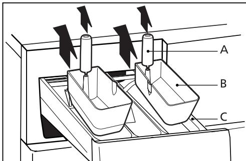
4. Reinigen Sie die Flüssigkeitsbehälter und Saugheber unter fließendem Wasser.
