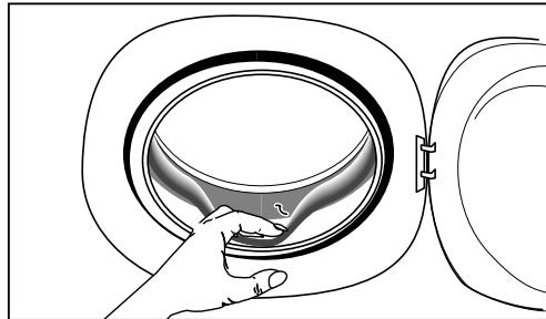
Lassen Sie die Einfülltür etwas geöffnet, damit das Gerät austrocknen kann.
