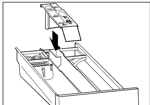
6. Setzen Sie die Waschmittelschublade in das Gerät ein.
