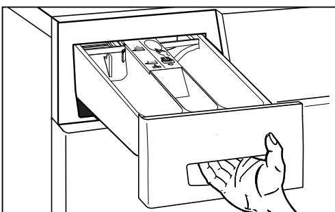
► Ziehen Sie die Waschmittelschublade bis zum Anschlag heraus. Wasch- oder Pflegemittel in die Kammer I, II oder III einfüllen:
