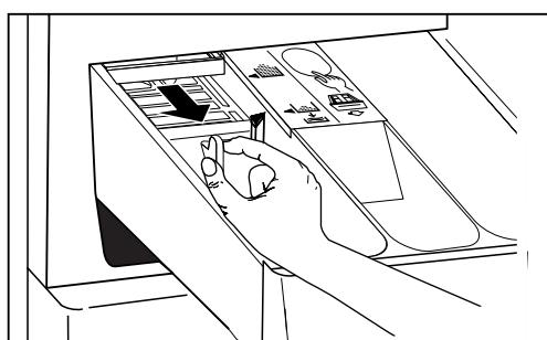
A seconda dei tipi e della quantità di detersivo, è possibile spostare l'inserto della vaschetta II.
