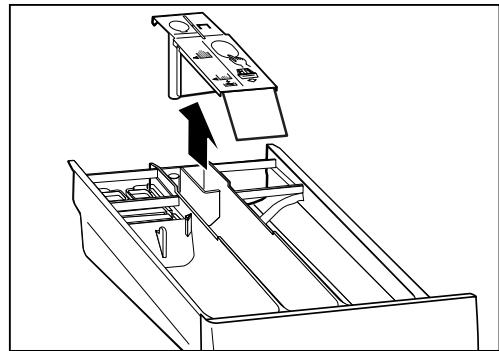
4. Reinigen Sie Kammern und Einsatz unter fliessendem Wasser.
