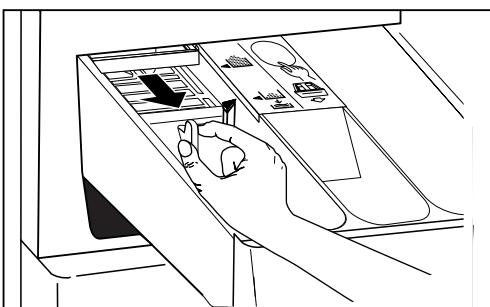
Für die verschiedenen Arten und Mengen von Waschmitteln kann der Einsatz in Kammer II verschoben werden. Wenn Sie geringe Mengen Waschpulver, z.B. Kompaktwaschmittel, verwenden:
