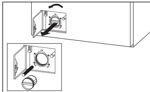
5. Fremdkörper und Flusenablagerungen entfernen. Pumpinnenraum reinigen. Pumpenflügel müssen sich drehen lassen.
