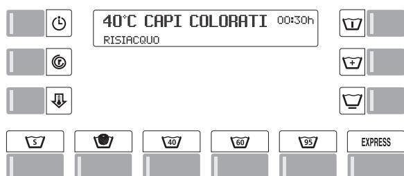
Durante l'esecuzione del programma di lavaggio vengono visualizzate sul display le singole fasi e il tempo residuo.
