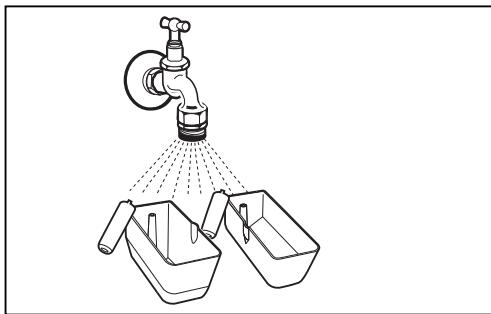
5. Entfernen Sie Verschmutzungen z.B. Waschmittelrückstände mit einem geeigneten Reinigungsgerät z.B. Nylon-Bürste.
