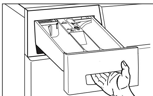
► Estrarre il cassetto per i detersivi fino alla battuta d'arresto. Inserire il detersivo o l'additivo nella vaschetta I, II oppure ☀:
