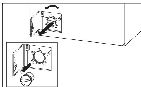
5. Enlevez les corps étrangers et les dépôts de peluches. Nettoyez l'intérieur de la pompe. Les ailettes de celle-ci doivent pouvoir tourner.
