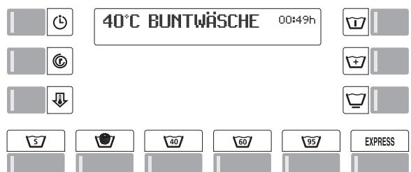
Nach der Programmwahl blinken die Kontrolllampen der Zusatzfunktionen, die bei Bedarf zugeschaltet werden können.
