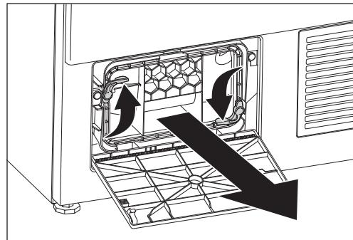
► Streichen Sie mit der Hand oder einem feuchten Tuch über den Filter (C) und entfernen Sie dadurch die Flusen.
