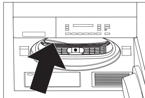
Après une certaine période de fonctionnement, des minces dépôts (calcaire, adoucissants) peuvent se former à la surface des capteurs d'humidité situés en façade à l'intérieur du tambour. Lorsque vous utilisez un programme piloté par le taux d'humidité, ceci peut empêcher l'obtention du résultat de séchage désiré.
