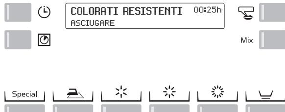
► Nei programmi in base all'umidità residua il sistema di rilevamento elettronico controlla costantemente il grado d'umidità della biancheria.
