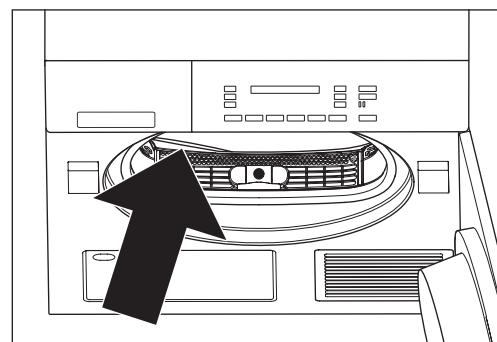
Nach längerer Betriebszeit können sich auf den beiden länglichen Feuchtigkeitssensoren an der Front-Innenseite der Trommel feine Ablagerungen (Kalk, Gewebeveredler) bilden. Bei feuchtegesteuerten Programmen kann dies dazu führen, dass das gewünschte Trocknungsziel nicht erreicht wird.
