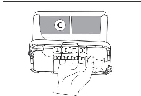
► Setzen Sie den Filter wieder ein und verriegeln Sie die blauen Hebel.
