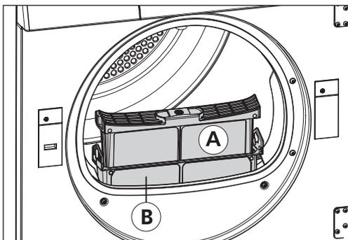
► Führen Sie das Staubsaugerrohr bzw. den Reinigungspinsel in die Vertiefung des Filterhalters.
