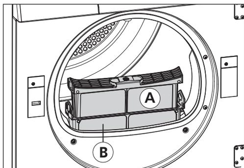
► Introduisez le tube de l'aspirateur ou le pinceau de nettoyage dans l'ouverture du filtre à peluches.
