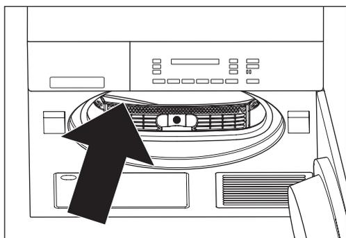
Dopo un uso prolungato si possono formare dei fini sedimenti di calcare o ammorbidente sulla parte frontale ed interna del tamburo, su entrambi i rilevatori d'umidità. Nei programmi in base all'umidità residua questo può comportare il mancato raggiungimento del grado di asciugatura desiderato.
