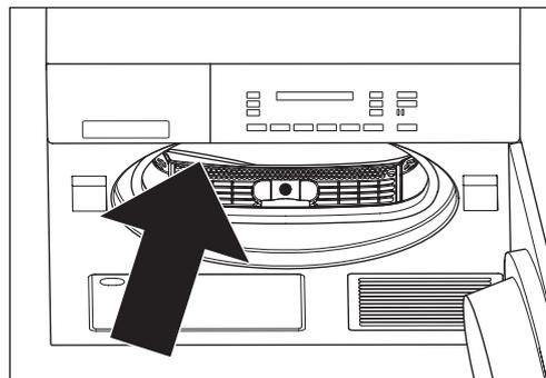
Après une certaine période de fonctionnement, des minces dépôts (calcaire, adoucissants) peuvent se former à la surface des capteurs d'humidité situés en façade à l'intérieur du tambour. Lorsque vous utilisez un programme piloté par le taux d'humidité, ceci peut empêcher l'obtention du résultat de séchage désiré.
