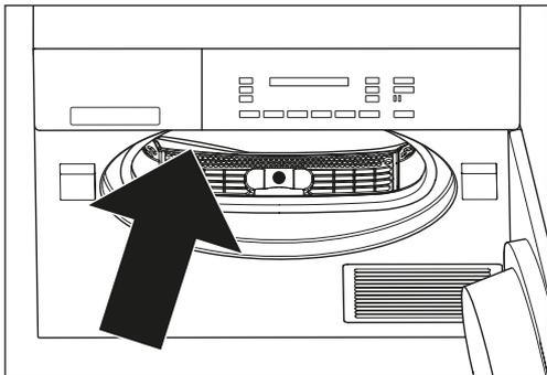
Nach längerer Betriebszeit können sich auf den beiden länglichen Feuchtigkeitssensoren an der Front-Innenseite der Trommel feine Ablagerungen bilden (Kalk, Gewebeveredler). Bei feuchtegesteuerten Programmen kann dies dazu führen, dass das gewünschte Trocknungsziel nicht erreicht wird.
