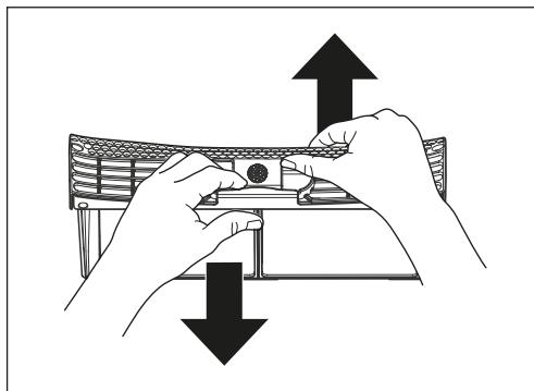
► Streichen Sie mit der Hand über den Filter und entfernen Sie so die Flusen.
