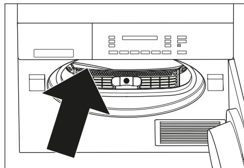
Nach längerer Betriebszeit können sich auf den beiden länglichen Feuchtigkeitssensoren an der Front-Innenseite der Trommel feine Ablagerungen bilden (Kalk, Gewebe veredler). Bei feuchtegesteuerten Programmen kann dies dazu führen, dass das gewünschte Trocknungsziel nicht erreicht wird.
