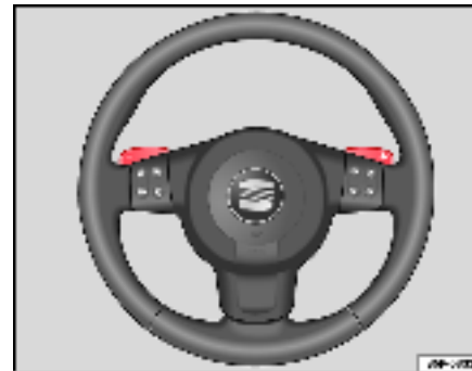
Fig. 143 Volant avec leviers pour boîte de vitesses automatique ▶
