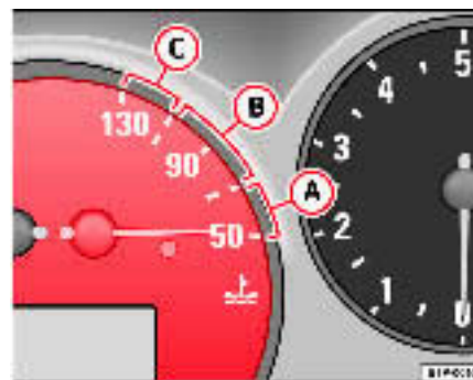
Fig. 35 Détail du combiné d'instruments : indicateur de température de liquide de refroidissement
