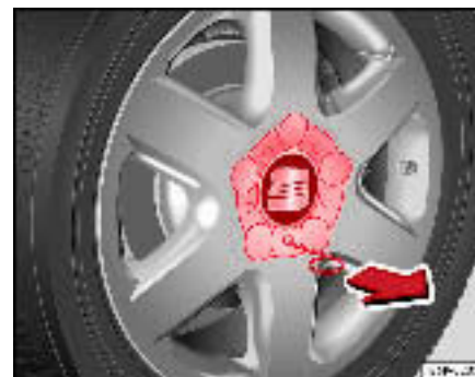
Fig. 174 Changement de roue : Retirez l'enjoliveur de roue central.
