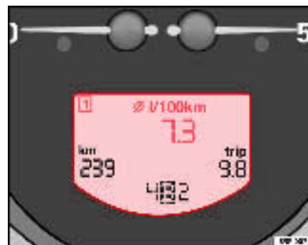
Fig. 40 Afficheur numérique du combiné d'instruments : indicateur consommation moyen de carburant
