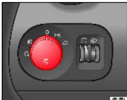
Fig. 73 Détail du tableau de bord : commande des feux, des projecteurs antibrouillard et du feu arrière de brouillard
