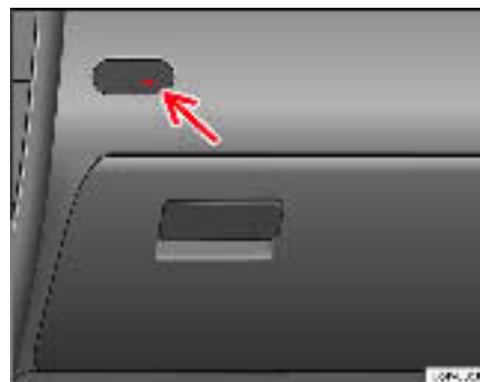
Fig. 27 Témoin de désactivation de l'airbag du passager
