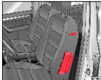
Fig. 22 Airbag latéral dans le siège du conducteur
