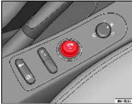
Fig. 116 Allume-cigare branché dans la prise de courant de la console centrale avant
