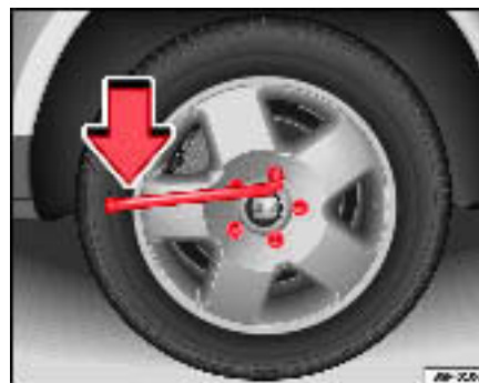
Fig. 175 Changement de roue : dévissez les vis de roue
