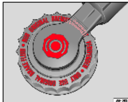
Fig. 170 Dans le compartiment-moteur : bouchon du réservoir de liquide de frein
