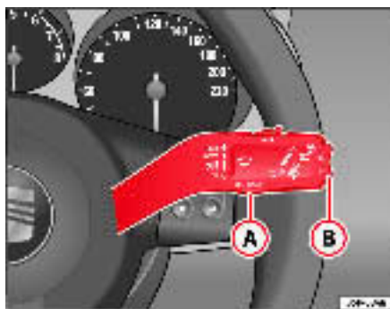
Fig. 43 Levier de l'essuie-glace : la touche A sert à confirmer les options du menu et la commande à bascule B permet de changer de menu
