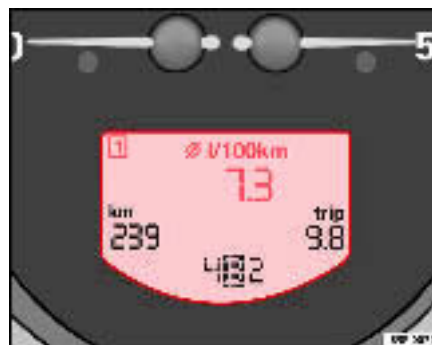
Fig. 42 Afficheur numérique du combiné d'instruments : indicateur consommation moyen de carburant.
