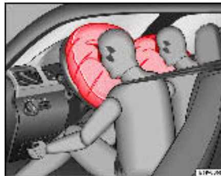
Fig. 20 Schéma de principe : airbags frontaux gonflés
