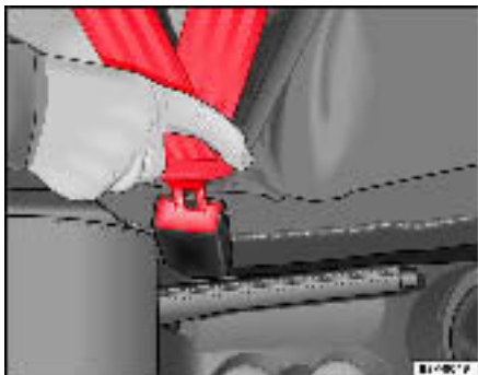
Fig. 12 Boîtier de verrouillage et pêne de la ceinture de sécurité
