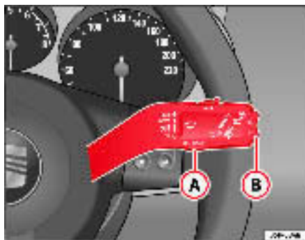
Fig. 45 Levier de l'essuie-glace : la touche A sert à confirmer les options du menu et la commande à bascule B permet de changer de menu
