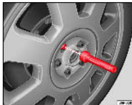
Fig. 178 Changement de roue : Outil à hexagone intérieur pour tourner les vis
