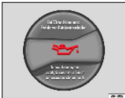
Fig. 164 Dans le compartiment-moteur : bouchon de l'orifice de remplissage d'huile-moteur
