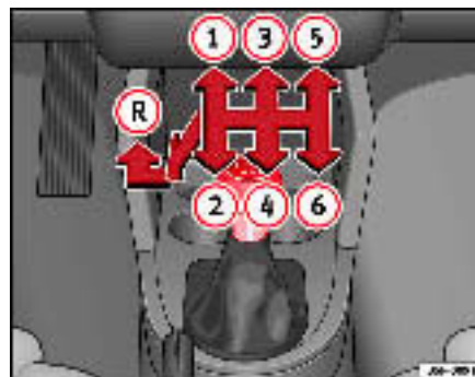
Fig. 137 Détail de la console centrale : schéma d'une boîte de vitesses de 6 marches
