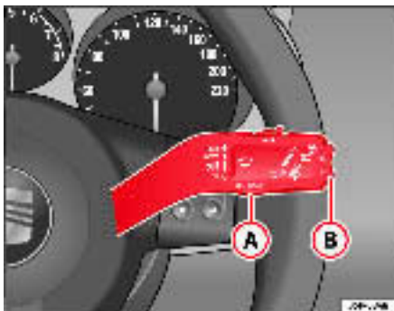
Fig. 39 Levier d'essuie-glace/de lave-glace : touche A et commande à bascule B
