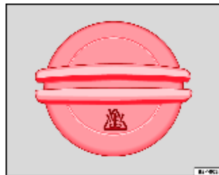
Fig. 165 Dans le compartiment-moteur : bouchon du vase d'expansion du liquide de refroidissement
