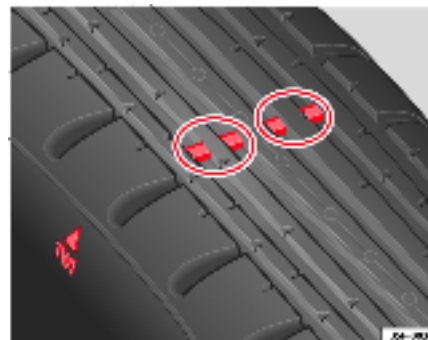
Fig. 171 Sculptures du pneu : indicateurs d'usure
