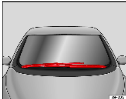
Fig. 167 Essuie-glace en position de maintenance
