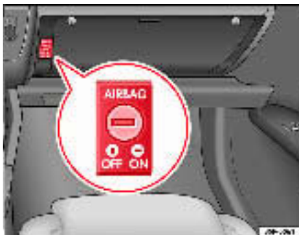
Fig. 26 Dans la boîte à gant : commande à clé pour commuter et désactiver les sacs gonflables côté passager avant
