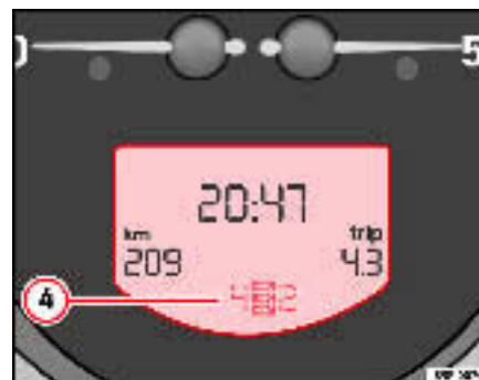
Fig. 37 Détail du combiné d'instruments : afficheur avec indication du rapport en mode tiptronic
