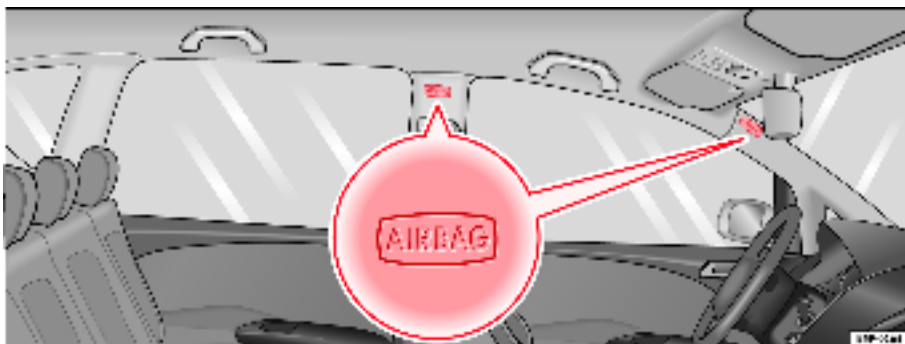
Fig. 24 Emplacement de montage des airbags de tête du côté gauche du véhicule
