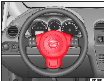
Fig. 18 Emplacement de montage de l'airbag du conducteur : dans le volant de direction
