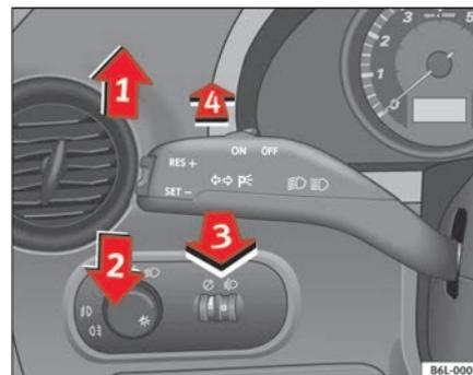
**Fig. 61** Levier des clignotants et de l'inverseur-codes
