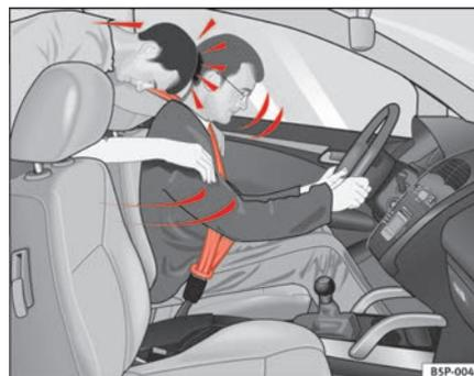
**Fig. 9** Le passager arrière non sanglé est projeté en avant et vient heurter le conducteur sanglé.
