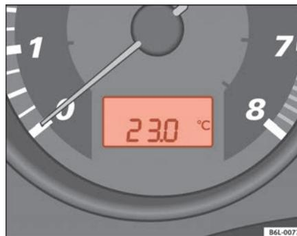
Fig. 38 Afficheur numérique du combiné d'instruments : indicateur de la température extérieure
