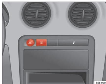
Fig. 60 Détail du tableau de bord : commande du signal de détresse
