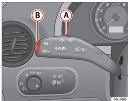
Fig. 109 Levier des clignotants et de l'inverseur-codes : commandes du régulateur de vitesse
