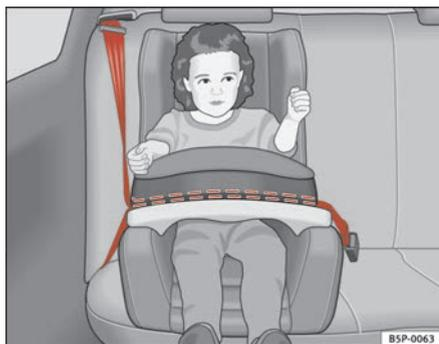
**Fig. 28** Siège pour enfant du groupe 1 monté dans le sens de la marche sur la banquette arrière.
