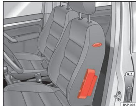
Fig. 21 Airbag latéral dans le siège du conducteur
