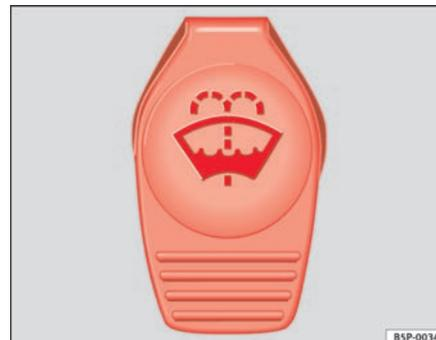
**Fig. 130** Dans le compartiment-moteur : bouchon du réservoir de lave-glace
