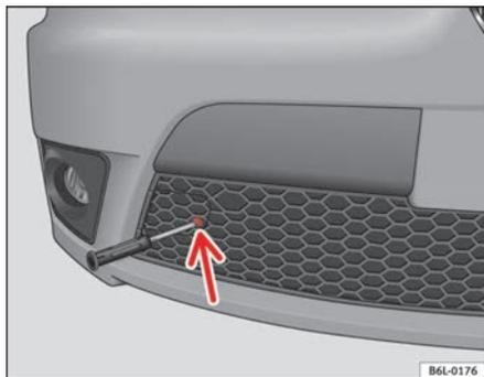
**Fig. 172** Cache-œillet situé dans la grille centrale inférieure
