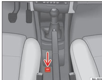
Fig. 99 Détail de la console centrale : touche ESP
