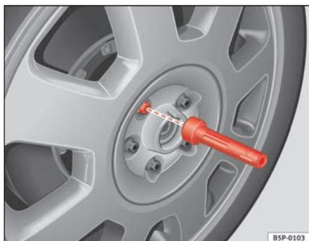
Fig. 144 Changement de roue : outil à six pans creux pour tourner les boulons
