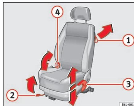
Fig. 75 Éléments de commande du siège avant gauche
