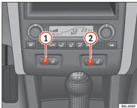
Fig. 76 Molettes des chauffages de sièges avant
