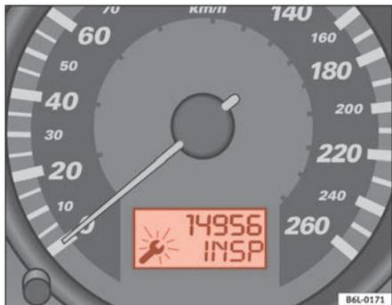
Fig. 39 Indicateur de maintenance
