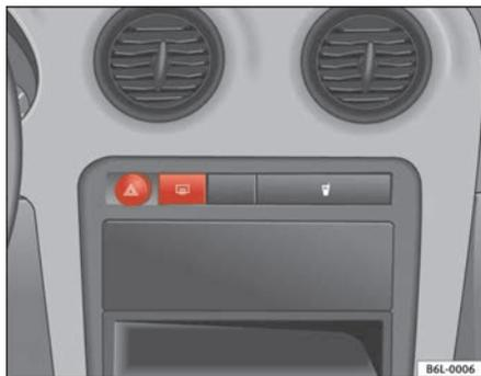
Fig. 59 Tableau de bord : contacteur de dégivrage de lunette arrière
