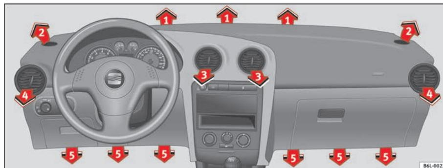
Fig. 93 Diffuseur d'air
