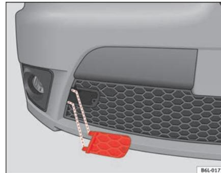
**Fig. 173** Cache-œillet situé dans la grille centrale inférieure
