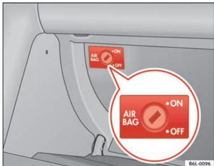
Fig. 25 Dans le vide-poches : commande à clé pour commutation et désactiver les sacs gonflables côté passager avant
