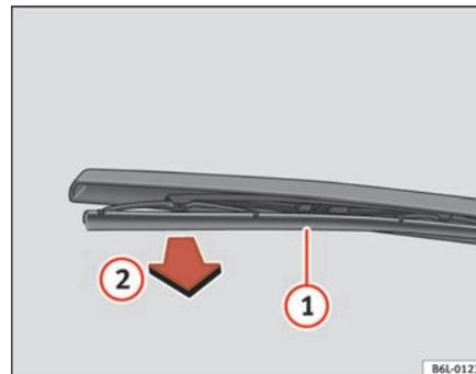
**Fig. 132 Remplacement du balai d'essuie-glace arrière**
