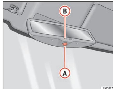
**Fig. 70** Rétroviseur intérieur avec réglage automatique de position anti-éblouissement.
