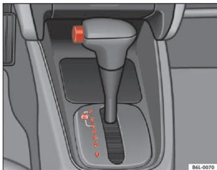
**Fig. 103** Détail de la console centrale : levier sélecteur de la boîte automatique
