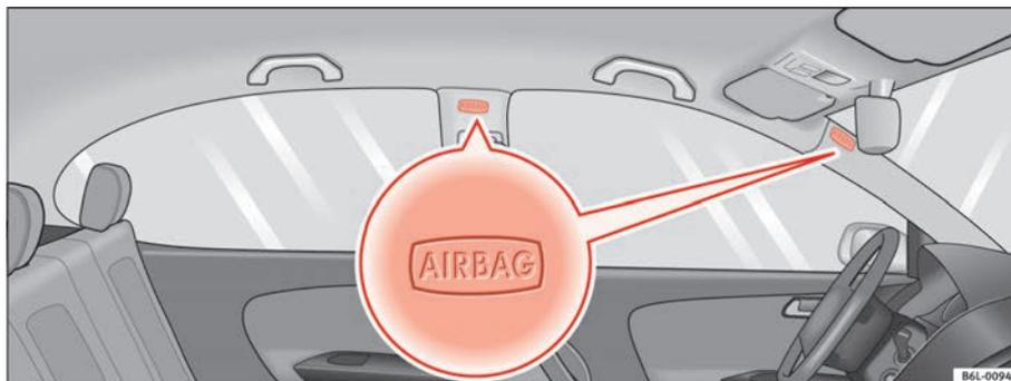
**Fig. 23** Emplacement de montage des airbags de tête du côté gauche du véhicule
