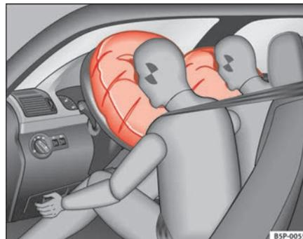
**Fig. 19 Schéma de principe : airbags frontaux gonflés**
