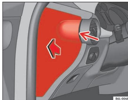
Fig. 146 Fusibles dans combiné d'instruments
