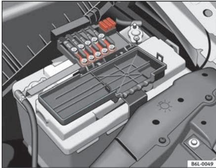
Fig. 147 Boîtier de fusibles sur la batterie
