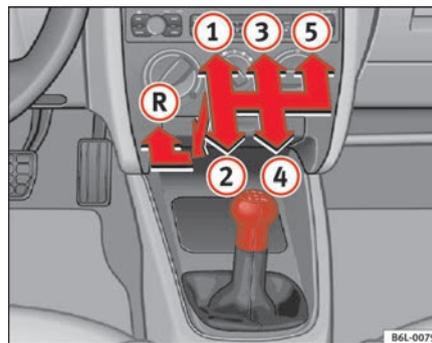
Fig. 101 Console centrale : schéma de la boîte mécanique à 5 vitesses
