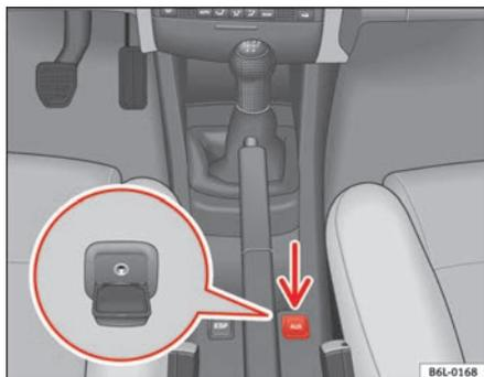
Fig. 87 Connecteur pour l'entrée auxiliaire audio
