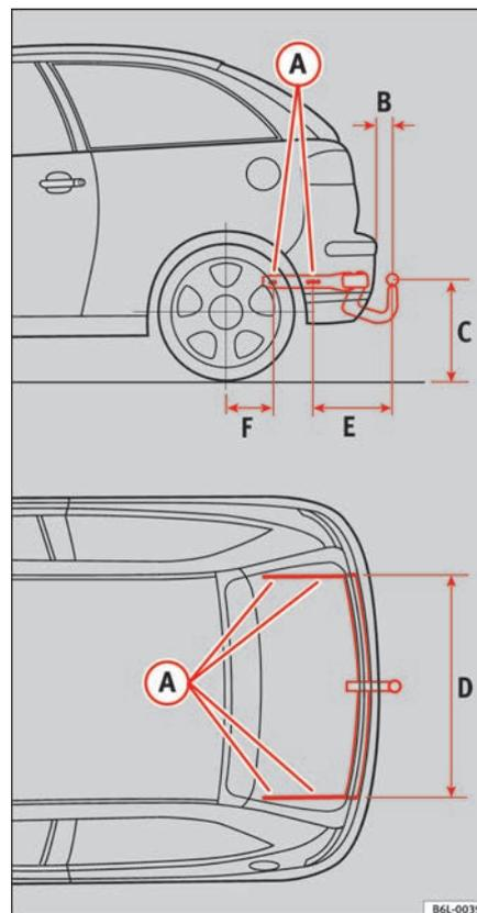
Fig. 123 Points de fixation du dispositif d'attelage
