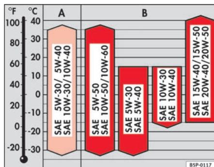
Fig. 126 Types d'huile en fonction de la température
