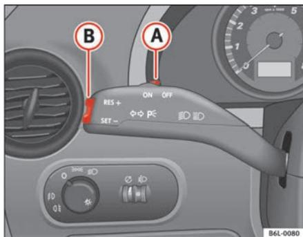
Fig. 110 Levier des clignotants et de l'inverseur-codes : commandes du régulateur de vitesse
