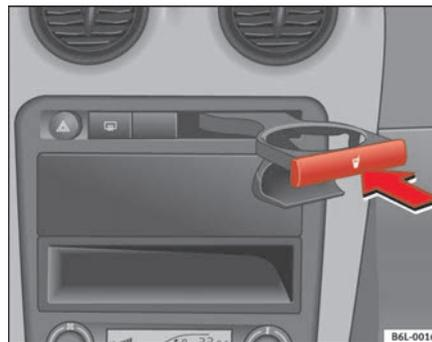
Fig. 83 Porte-gobelets avant dans la console centrale
