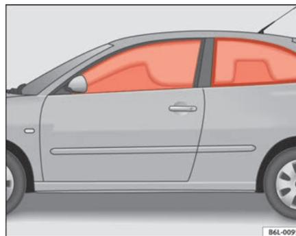
**Fig. 24 Schéma de principe : airbags de tête gonflés**
