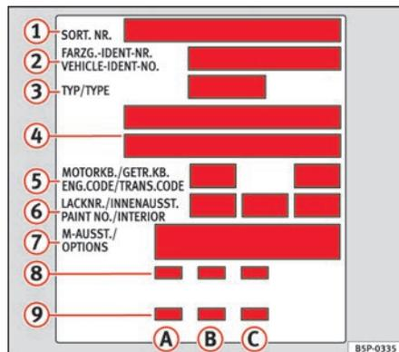
Fig. 176 Autocollant d'identification du véhicule - coffre à bagages
