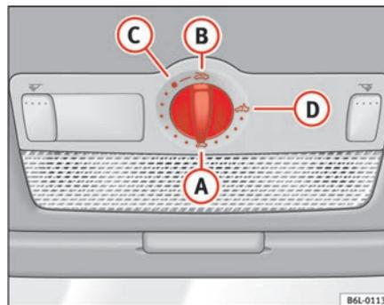
Fig. 55 Détail du revêtement du ciel de pavillon : commande rotative du toit ouvrant coulissant/relevable
