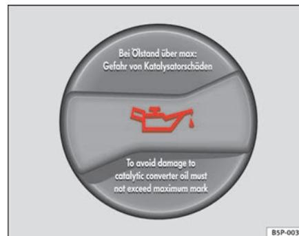
**Fig. 128** Dans le compartiment-moteur : bouchon de l'orifice de remplissage d'huile-moteur
