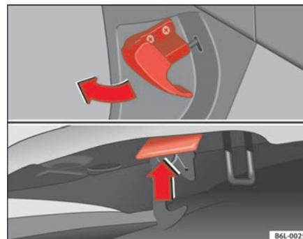
**Fig. 125** Gâchette d'ouverture du capot-moteur.
