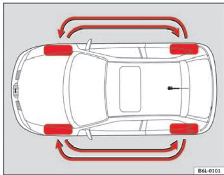
Fig. 135 Schéma de permutation des roues
