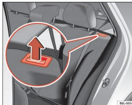
Fig. 78 Touche de déverrouillage du dossier arrière
