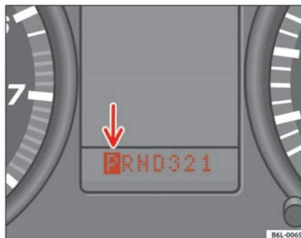
**Fig. 104** Afficheur numérique du combiné d'instruments : blocage du levier de sélection sur la position P
