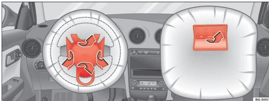
**Fig. 20** Schéma de principe : comportement des caches des modules d'airbags lors du déclenchement des airbags frontaux
