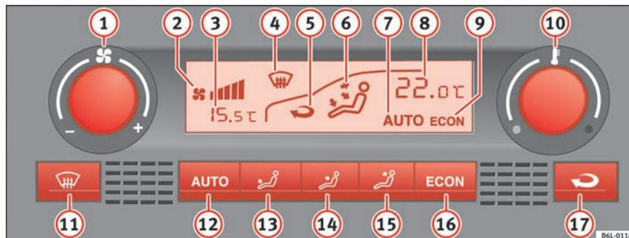
Fig. 96 Sur le tableau de bord : éléments de commande du Climatronic
