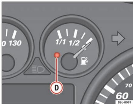
Fig. 34 Indicateur de niveau du réservoir de carburant
