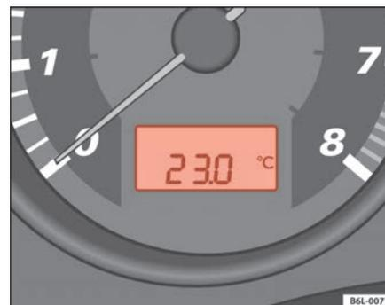
Fig. 36 Afficheur numérique du combiné d'instruments : indicateur de la température extérieure
