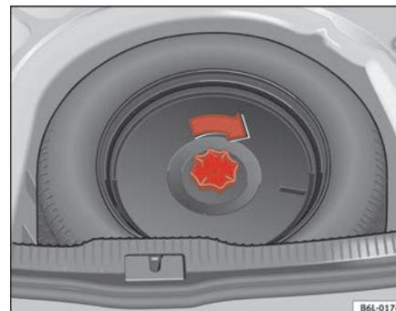
Fig. 138 Fixation de la roue remplacée
