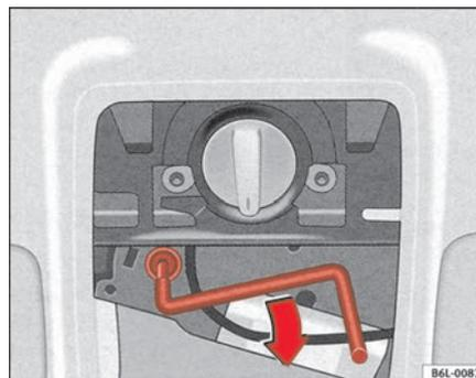
Fig. 56 Manivelle de fermeture d'urgence
