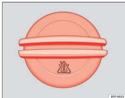
**Fig. 129** Dans le compartiment-moteur : bouchon du vase d'expansion du liquide de refroidissement
