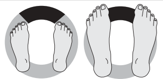
Calcanhares centrados nos eletrodos. Os dedos dos pés podem ultrapassar a plataforma de medição.
