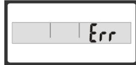
Indication de surcharge. Le poids sur la plate-forme dépasse la capacité maximale de la balance. Veuillez descendre de la plate-forme pour ne pas endommager l'appareil.
