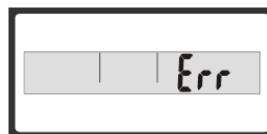
Indicazione di sovraccarico. Il peso posto sulla piattaforma supera la capacità massima della bilancia. Si prega di scendere dalla bilancia per evitare danni.
