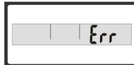
Indikace přetížení. Vážený předmět na ploše přesahuje maximální kapacitu váhy
