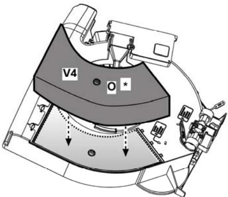
Ersetzen der Halogenlampe
