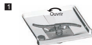
Étape 1 : Dévissez le filtre à déchets et soulevez-le.
