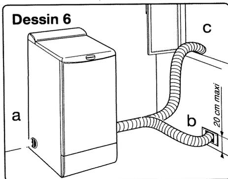
c) soit, de façon temporaire, en faisant sortir l'extrémité de la gaine par une fenêtre ouverte.
