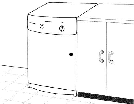
Votre sèche-linge dégage de la chaleur, si vous le placez à côté d'un autre appareil ou d'un meuble, laissez de l'espace pour faciliter la circulation de l'air. Si vous le glissez sous un plan de travail, veillez à laisser un espace suffisant (15 mm minimum) pour que l'air puisse entrer par la grille d'aération arrière.
