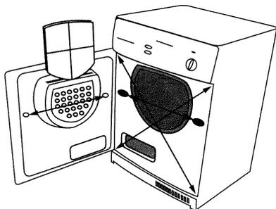
Vous pouvez facilement modifier le sens d'ouverture de la porte, en inversant les charnières de fixation et les caches correspondant en diagonale, et en inversant le loquet de la porte et l'ouverture avec les caches situés à l'opposé.
