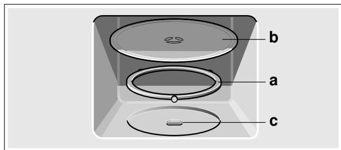
**Hinweis:** Benutzen Sie das Gerät nur mit eingesetztem Drehteller. Achten Sie darauf, dass er richtig eingerastet ist. Der Drehteller kann sich links oder rechts herum drehen.
