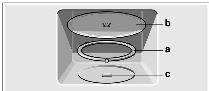
**Remarque :** Utilisez l'appareil uniquement avec le plateau tournant en place. Veillez à ce qu'il soit correctement enclenché. Le plateau tournant peut tourner à gauche ou à droite.
