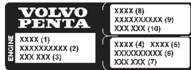
Moteur / Transmission / Inverseur (autocollant d'informations)
