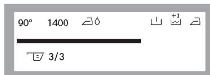
**Remarque :** 3/3 signifie un tiroir à lessive plein. La quantité de lessive sur l'écran doit être adaptée à la quantité mise dans la pelle à lessive de la machine.
