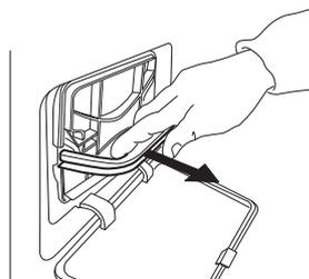
Enlevez la mousse du filtre inférieur, pour le nettoyer. Nettoyez la mousse du filtre et le filtre à la main ou sous l'eau courante. Ne le lavez pas dans la machine à laver. Essorez la mousse du filtre. Ne l'insérez pas dans le filtre inférieur trop humide.
