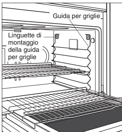
Rimozione delle guide delle griglie del forno
