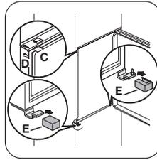
Bevestig de afdekkingen (C, D) aan de uitsteeksels en de gaten van de scharnieren. Bevestig de scharnierafdekkingen (E) op het scharnier.
