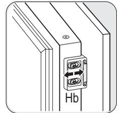
Plaats het kleine vierkantje op de geleider terug en bevestig het met de bijgeleverde schroeven. Lijn de deur van het keukenmeubel en de deur van het apparaat uit met behulp van onderdeel Hb.
