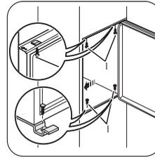
Befestigen Sie das Gerät mit 4 Schrauben in der Nische.
