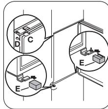
Setzen Sie die beiliegenden Abdeckkappen (C, D) in die Befestigungs- und Scharnierlöcher ein.
