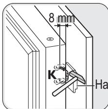
Nehmen Sie das Führungsstück (Hb) wieder ab. Schlagen Sie 8 mm von der Außenkante mit dem Nagel (K) und einem Hammer je ein kleines Loch in das Türblech.
