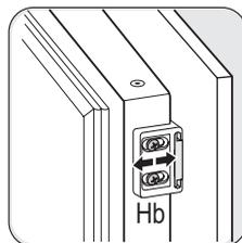
Placez à nouveau la petite équerre sur le guide et fixez-la à l'aide des vis fournie. Alignez la porte du meuble de cuisine et la porte de l'appareil en ajustant la pièce Hb.
