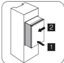
Insérez l'appareil dans le meuble d'encastrement. Poussez l'appareil dans le sens indiqué par les flèches (1) jusqu'à ce que le cache de l'ouverture supérieure s'aligne par rapport au meuble de cuisine. Vérifiez que la distance entre l'appareil et le rebord avant du placard est de 44 mm. Poussez l'appareil dans le sens indiqué par les flèches (2) contre le placard, du côté opposé à la charnière. Assurez-vous qu'il y a un écart de 4 mm entre l'appareil et le placard.
