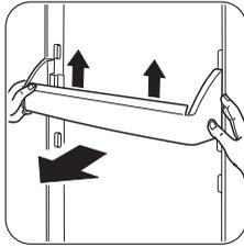
Ziehen Sie den Türeinsatz langsam in Pfeilrichtung, bis er sich herausheben lässt. Dann setzen Sie ihn in die gewünschte Position ein.
