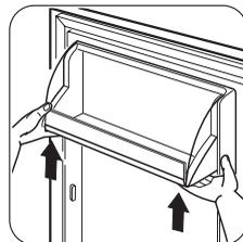
Tirez progressivement dans le sens des flèches pour les dégager, puis repositionnez-les selon les besoins.
