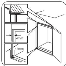
Réglez la position de l'appareil dans le meuble d'encastrement. Le cache de la charnière inférieure (disponible dans le sachet des accessoires) garantit une distance correcte entre l'appareil et le meuble. Ouvrez la porte. Installez le cache de la charnière inférieure.
