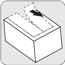
Brechen Sie das gekennzeichnete Teil aus der Scharnierabdeckung (E) heraus. Achten Sie darauf, beim rechten Scharnier Teil DX bzw. beim anderen Scharnier Teil SX abzunehmen.
