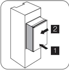
Installieren Sie das Gerät in der Einbaunische.
