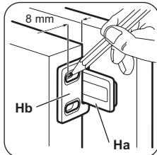
⑪ Ouvrez la porte de l'appareil et la porte du meuble de cuisine à un angle de 90 °C. Insérez le petit carré (Hb) dans le guide (Ha). Joignez la porte de l'appareil et la porte du meuble et repérez les trous.
