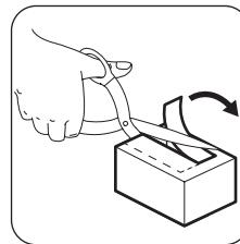
6 Verwijder het juiste onderdeel van de scharnieraafdekking (E). Verwijder onderdeel DX als het scharnier rechts staat, of onderdeel SX als het scharnier links staat.
