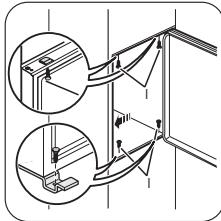
5 Fixez l'appareil au meuble d'encastrement à l'aide de 4 vis.
