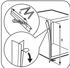
**1** Schneiden Sie bei Bedarf den Dichtungsstreifen zu und bringen Sie ihn, wie in der Abbildung gezeigt, am Gerät an.
