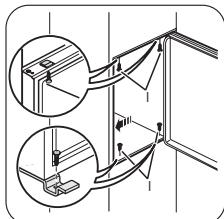
5 Sichern Sie das Gerät mit 4 Schrauben in der Nische.
