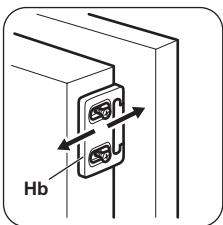
12 Setzen Sie das Führungsstück erneut auf die Führungsschiene und schrauben Sie es mit den mitgelieferten Schrauben fest. Richten Sie die Möbeltüre und die Gerätetür mittels des Führungsstücks (Hb) aus.
