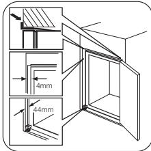
4 Ajustez la position de l'appareil dans le meuble d'encastrement.
