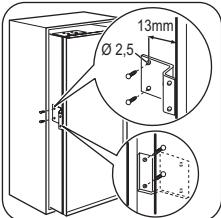
**2** Bohren Sie mit einem 2,5-mm-Bohrer Löcher in das Gerät (höchstens 10 mm tief). Montieren Sie den Befestigungswinkel am Gerät.
