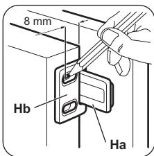
11 Öffnen Sie die Gerätetür und die Tür des Küchenmöbels in einem Winkel von 90°. Setzen Sie das Führungsstück (Hb) in die Führungsschiene (Ha) ein.
