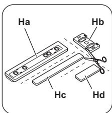
8 Trennen Sie die Teile (Ha), (Hb), (Hc) und (Hd) ab. Halten Sie die Gerätetür an die Tür des Küchenmöbels, und markieren Sie die Bohrungen.
