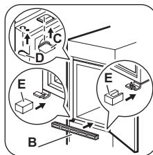
7 Bevestig de afdekplaatjes (C, D) aan de uitsteekels en de gaten van de scharnieren.
