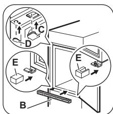
7 Setzen Sie die beiliegenden Abdeckkappen (C, D) in die Befestigungs- und Scharnierlöcher ein. Bauen Sie das Belüftungsgitter (B) ein. Stecken Sie die Scharnierabdeckungen (E) auf das Scharnier auf.
