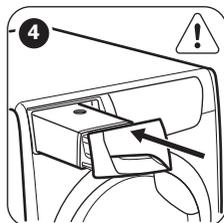
**i** Vous pouvez utiliser l'eau du bac d'eau de condensation comme eau distillée (par exemple pour les fers à vapeur). Avant d'utiliser l'eau, éliminez les résidus avec un filtre.
