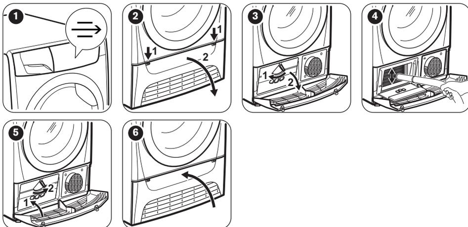
4 Verwijder indien nodig om de 6 maanden de pluizen uit het vak van de warmtewisselaar. U kunt hiervoor een stofzuiger gebruiken.
