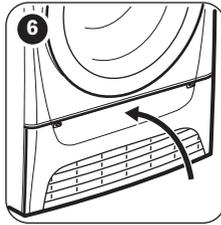
**4** Entfernen Sie, je nach Bedarf, alle 6 Monate die Flusen aus dem Wärmetauscherfach. Hierfür können Sie einen Staubsauger verwenden.
