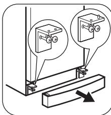
4. Schrauben Sie den oberen Bolzen ab und an der gegenüberliegenden Seite wieder an.
