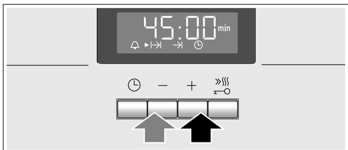
Le four se met en marche quelques secondes plus tard. Dans l'affichage, la durée s'écoule visiblement et le symbole
